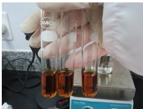
Figura 42 - Tubo de Reagente de DQO – Aspeto e cor
