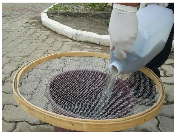
Figura 9 - Passagem manual do Esgoto Bruto pelo crivo.
