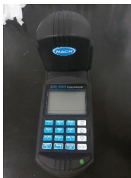
Figura 39 - Leitor Múltiplo de vários parâmetros, incluindo a Turvação 31
