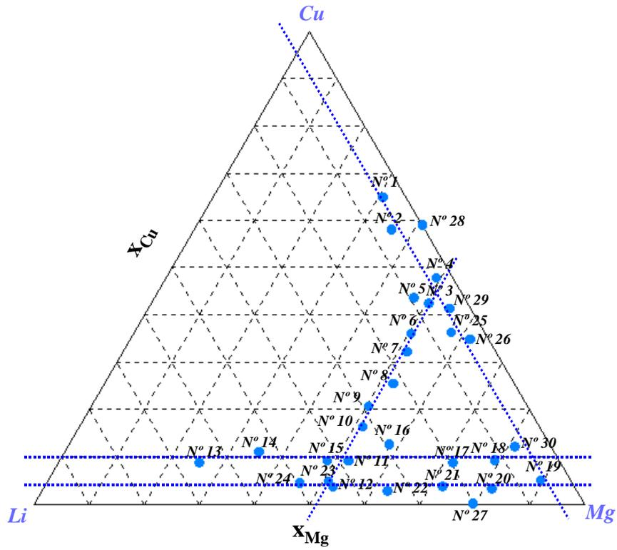
Figura 1 – Identificação, sobre o triângulo de Gibbs relativo ao sistema Cu-Li-Mg, da composição química das amostras estudadas. A tracejado estão representadas as linhas correspondentes às secções verticais estudadas.
