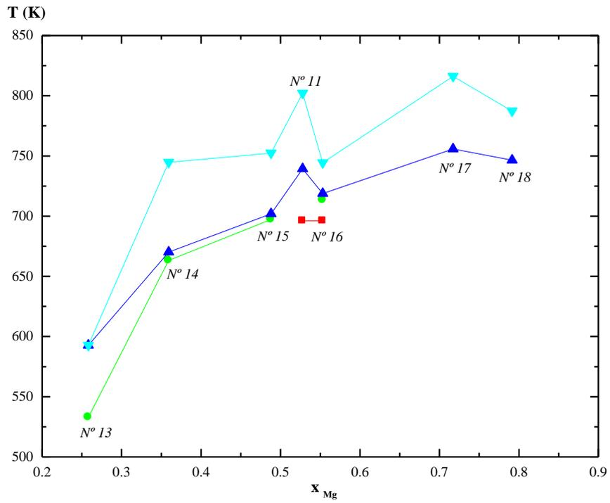
Figura 3 – Pontos experimentais obtidos a partir das curvas registadas nos ensaios de CDV/ATD com as amostras relativas à secção vertical para  $x_{Cu} = 0.097$ .
