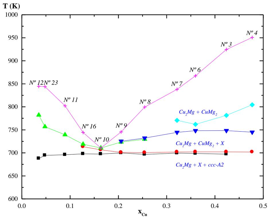
Figura 2 – Pontos experimentais obtidos a partir das curvas registadas nos ensaios de CDV/ATD com as amostras relativas à secção vertical para  $x_{Mg} = 0.512$ . Sobre a figura, são registadas as fases identificadas, por DRX a altas temperaturas, na amostra N° 6.
