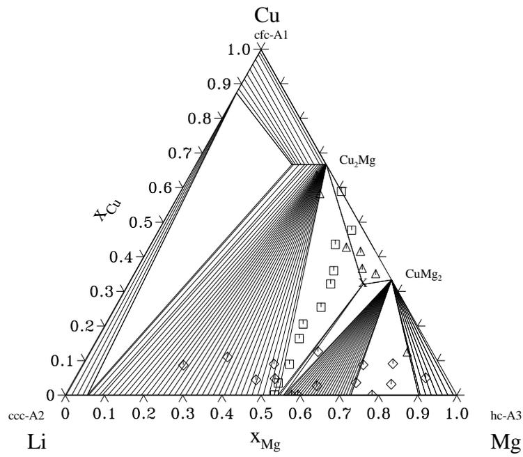
Figura 5 – Secção isotérmica, à temperatura ambiente, modelizada com os parâmetros obtidos pelos autores em [3].
