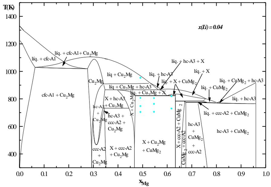
Figura 7 – Secção vertical, para  $x_{Li} = 0.04$ , modelizada com os parâmetros obtidos pelos autores em [3]; inserção dos pontos experimentais obtidos nos ensaios de CDV/ATD.
