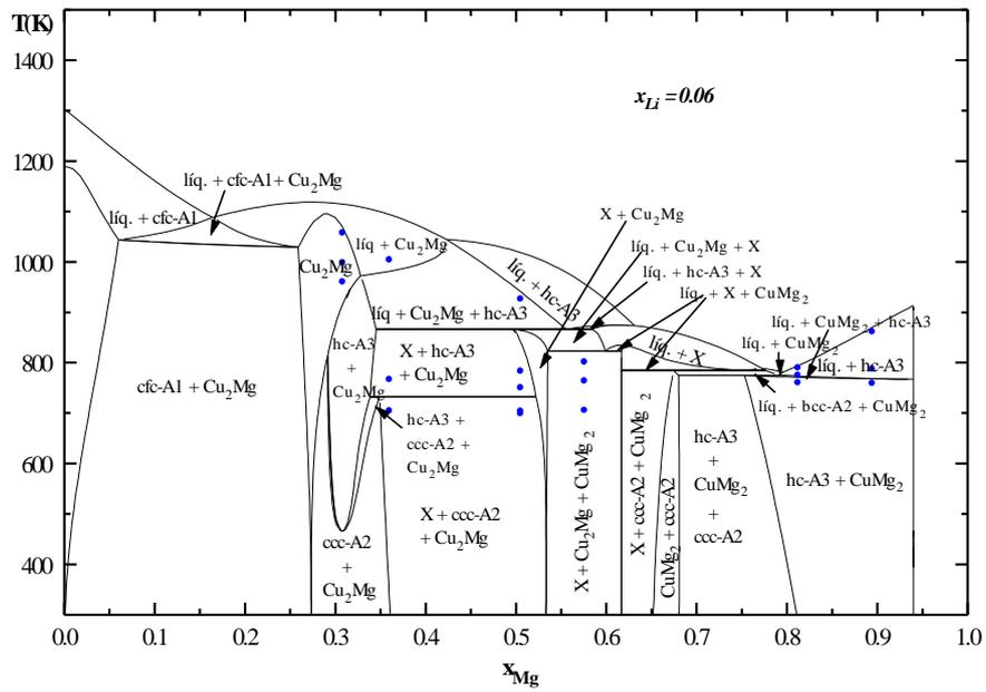
Figura 6 – Secção vertical, para  $x_{Li} = 0.06$ , modelizada com os parâmetros obtidos pelos autores em [3]; inserção dos pontos experimentais obtidos nos ensaios de CDV/ATD.
