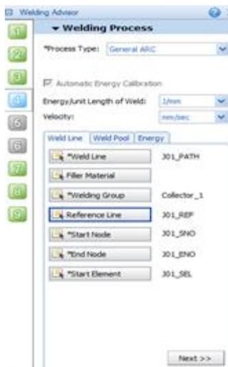
**Figura 113 - Assistente de soldadura, definição de parâmetros de soldadura #1**
