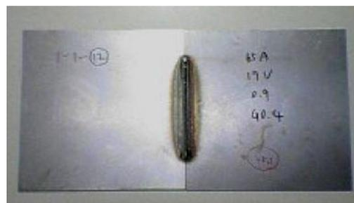
Figura 57 - Soldadura em chapas finas, [29]
