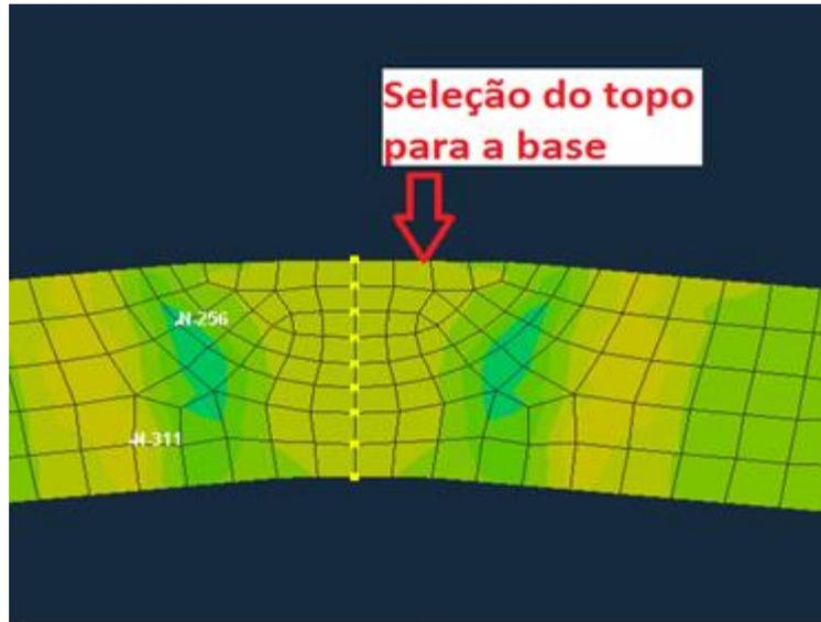
Figura 149 - Caminho para extracção dos valores das tensões residuais xx ao longo da espessura e respectiva cor nos gráficos
