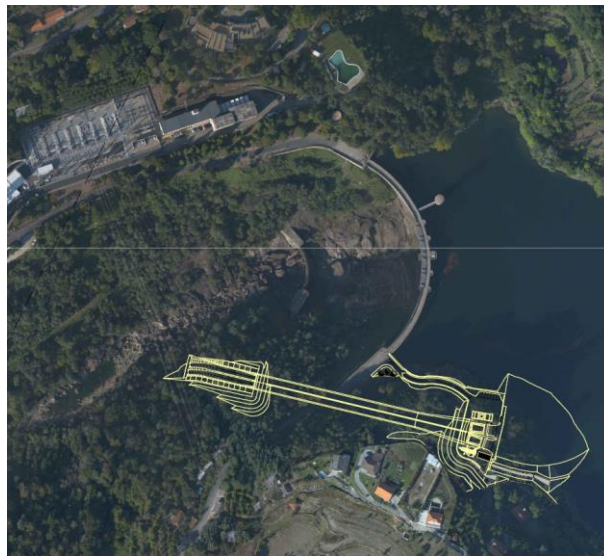
Fig. 5. 3 - Planta geral do descarregador complementar [35]
