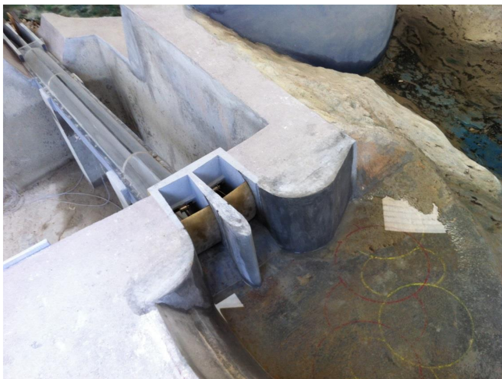
Fig. 5. 4 - Modelo reduzido do novo descarregador - LNEC
