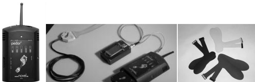
Figura 2.6 - Sistema de cabos, conectores e palmilhas do Sistema Pedar da Novel.
