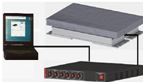
Figura 2.5 - Plataforma de forças Bertec, unidade de amplificação e conversor A/D, PC.
