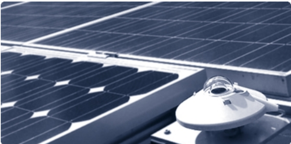
Figura 2.7: Exemplo de um piranómetro inserido numa instalação fotovoltaica [25]
