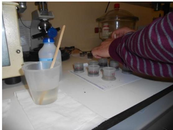
Figura 3.1 - Material de moldagem e respetiva mistura das preparações nos moldes, antes da secagem.
