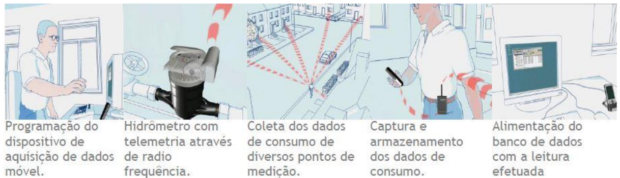
Figura 28 - Modo de funcionamento do sistema de telemetria de rádio móvel
