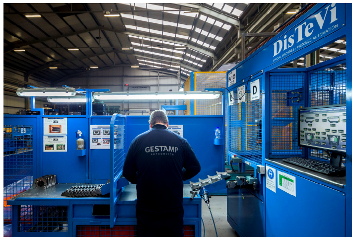
Figura 68.2. Área de trabalho do operador onde se podem ver as peças da direita e esquerda a saírem dos tapetes rolantes. Do lado direito destaca-se o monitor do controlo dimensional das peças.
