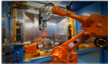
Figura 8. Soldadura laser robotizada [Gestamp1 2015]
