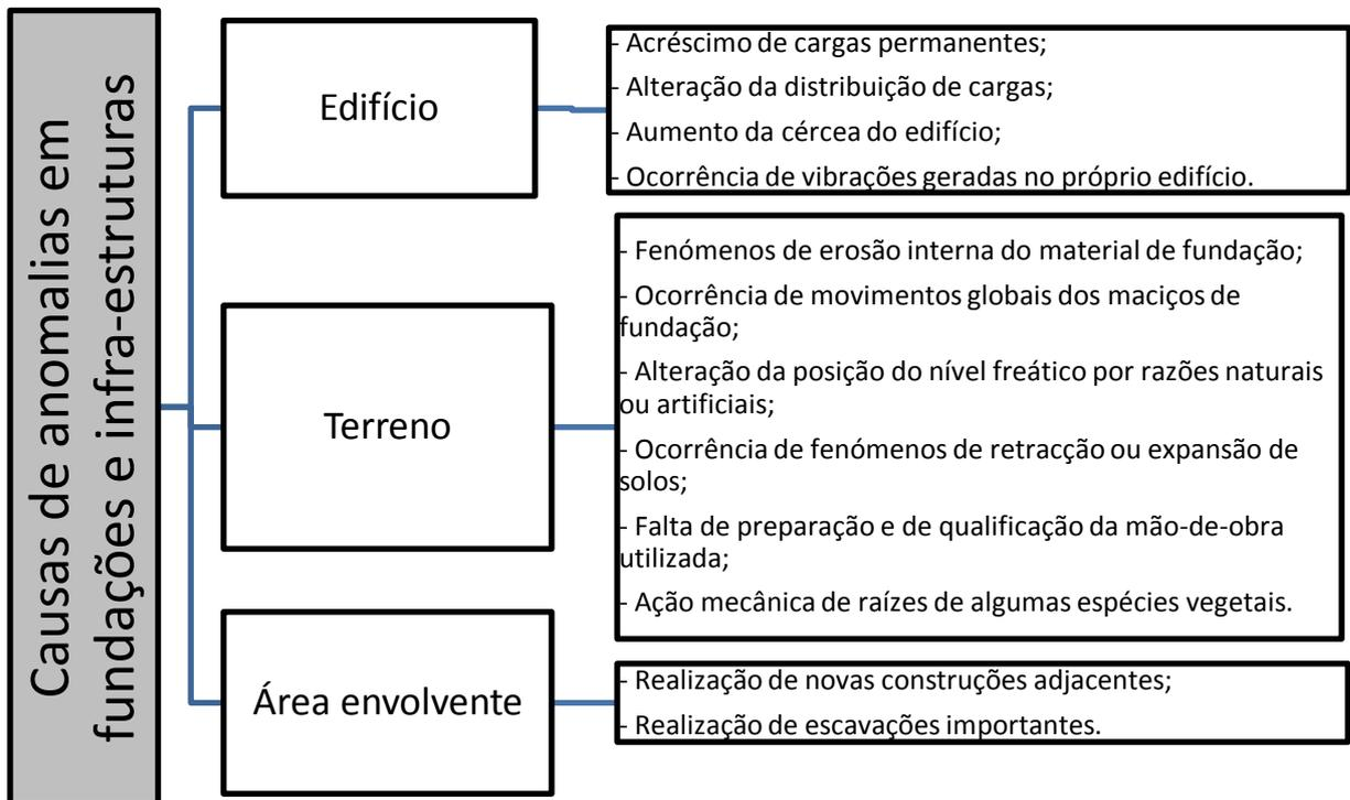
Fig. 35 – Representação das principais causas para o surgimento de anomalias em fundações e em infraestruturas (Aguiar *et al*/2006)
