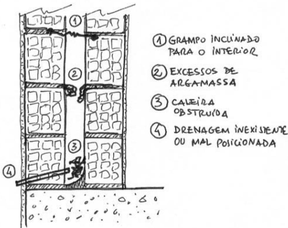
Fig. 45 – Algumas causas de anomalias em paredes duplas com caixa-de-ar
