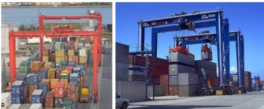
Figura 44 – Equipamentos *RTG's* – Fonte: [liebherr.com](http://liebherr.com) e [konecranes.com](http://konecranes.com)
