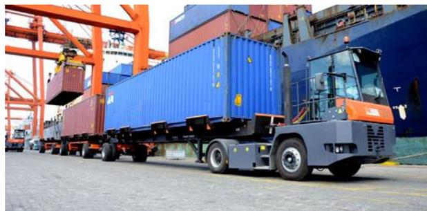
Figura 42 – Equipamento de transporte horizontal MTS – Fonte: portcalls.com
