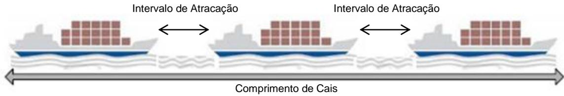
Figura 66 – Representação do comprimento de cais – Fonte: TU Delft, 2012
