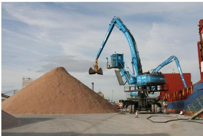
Figura 48 – Carregamento através de grua de garras – Fonte: Shoreham-port
