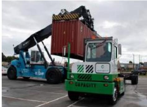
Figura 41 – Equipamentos de transporte horizontal TTU's – Fonte: conductix.com
