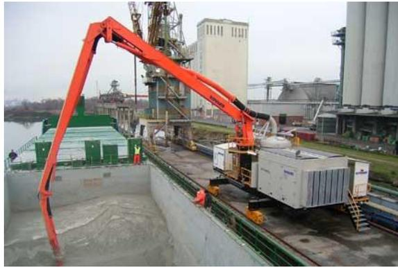
Figura 51 – Equipamento pneumático do tipo sucção – Fonte: Flsmidth
