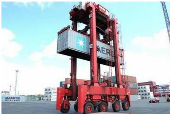
Figura 43 – Equipamento de transporte horizontal straddlecarrier – Fonte: internado.nl
