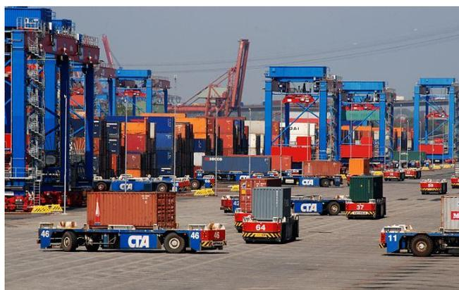
Figura 40 – Equipamento de transporte horizontal AGV – Fonte: bildarchiv-hamburg.de
