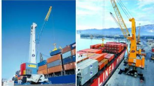
Figura 38 – Equipamento de cais guindaste móvel – Fonte: Gottwald
