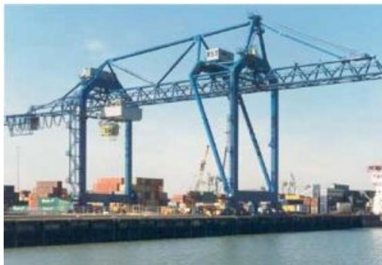
Figura 39 – Equipamento de cais guindaste de grande extensão – Fonte: tesindus.nl
