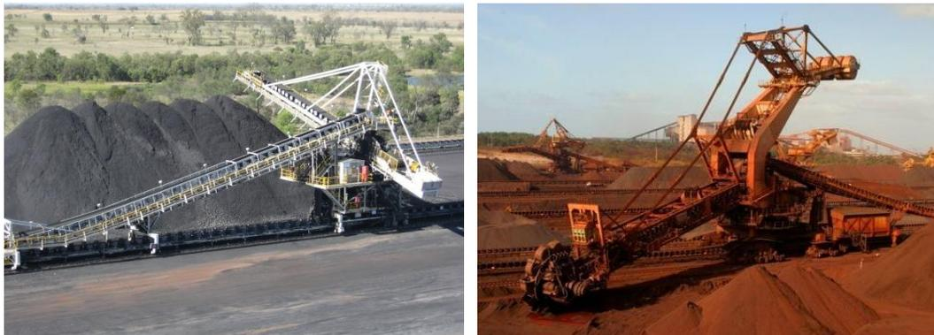
Figura 52 – Empilhador e empilhador-reclaimer em áreas de armazenagem – Fontes: Absoluteastronomy; Directindustry
