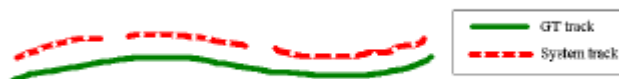
Figura 3.9: O número de fragmentações da trajetória é 2 (FN=2): quando comparada a trajetória do objeto de ground truth (linha contínua) e a trajetória do objeto estimado pelo sistema de seguimento (linha tracejada), vemos que esta última foi descontinuada duas vezes (Extraído de [96])
