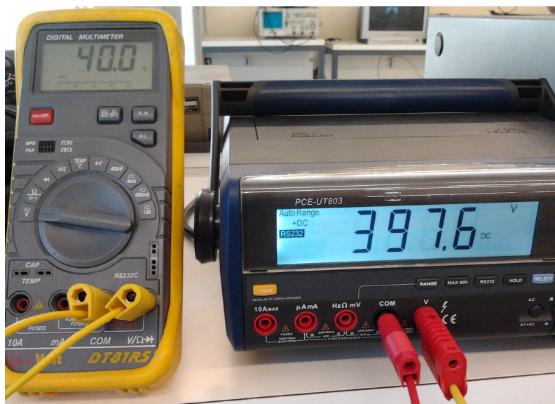
Figura 6.2: Tensão de entrada (à esquerda) e de saída (à direita).
