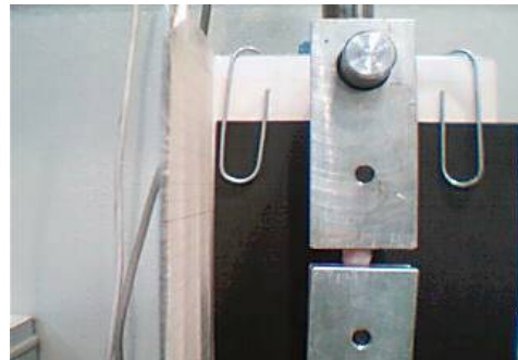
Fig. 4 Tracção da mucosa palatal de porco (vista frontal) desenvolvida por Martins et al. [4].
