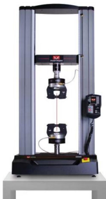
Figura 2.2 – Imagem da máquina de testes mecânicos de acionamento eletromecânico, da Instron , Modelo 5969 do sistema de teste da série 5900 [6].
