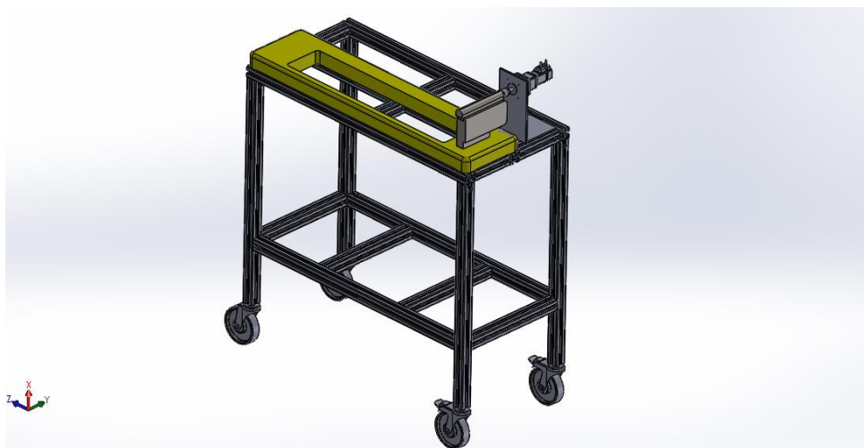
Figura 4.19 – Projeto em SolidWorks da mesa proposta para a máquina HT automatizada.
