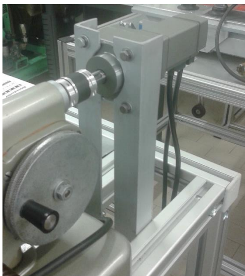
Figura 4.6 – Imagem da montagem do conjunto de atuação com o respetivo suporte.
