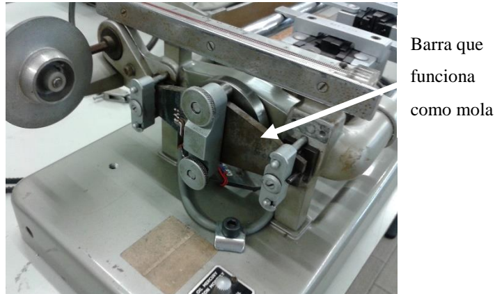
Figura 3.2 – Imagem da máquina HT com destaque para o local onde se insere a barra.
