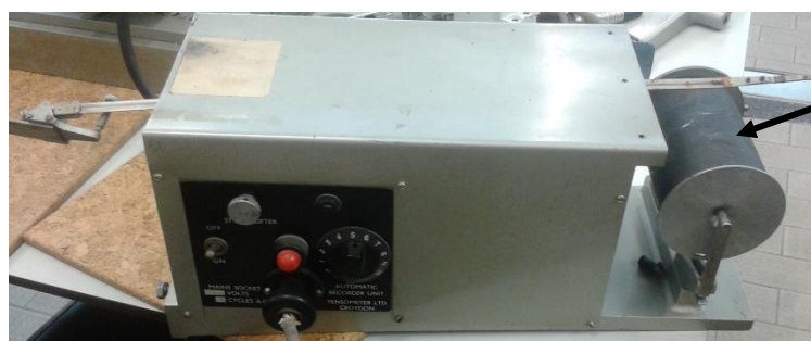
Figura 3.9 – Imagem do componente de registo automático da curva força vs. deslocamento do HT.
