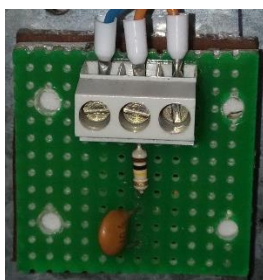
Figura 4.14 – Imagem do circuito do filtro RC passa-baixo implementado.
