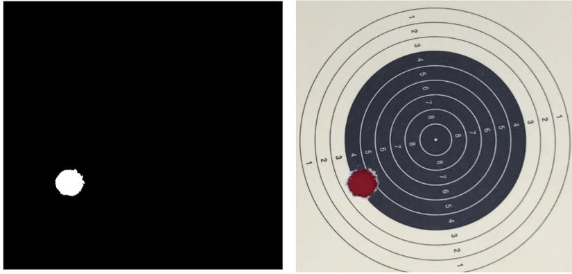
Figura 4.10: Aplicação de HSV para a detecção de vermelho
