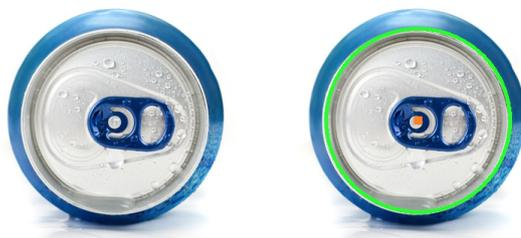
Figura 2.5: Deteção de círculos numa imagem usando a transformada de Hough [5]
