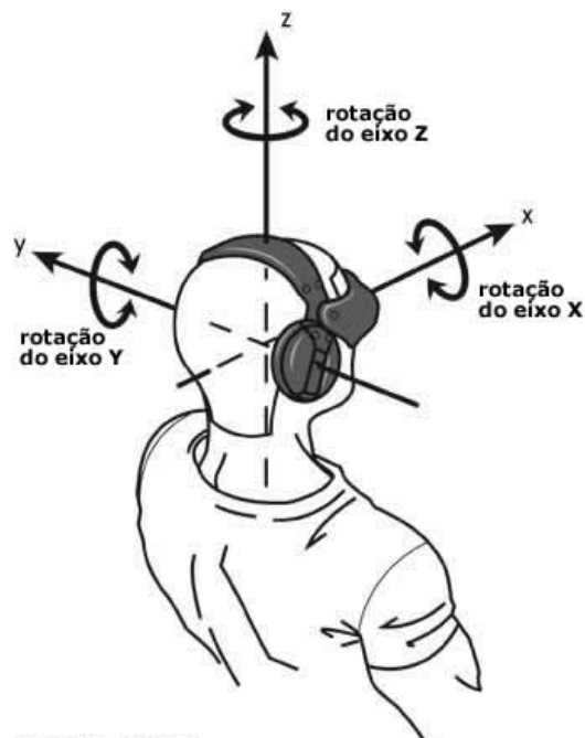
Figura 3. Representação dos 6 graus de liberdade em RV (adaptada de howstuffworks®)
