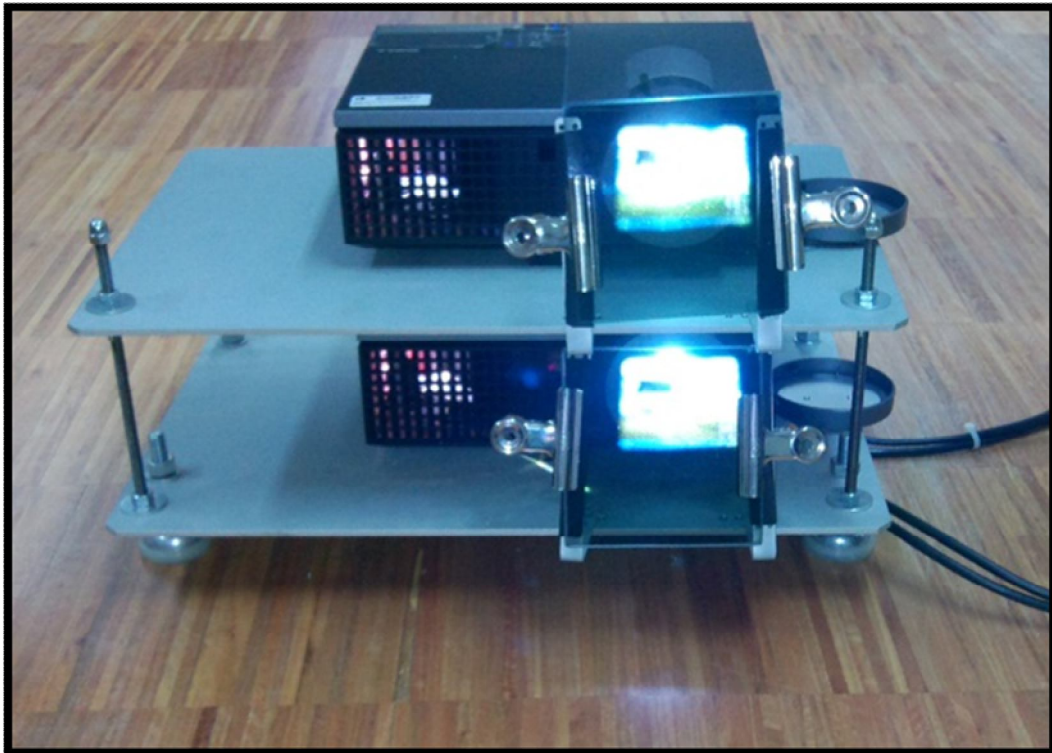
Figura 17. Pormenor com projectores estereoscópicos na retaguarda da tela
