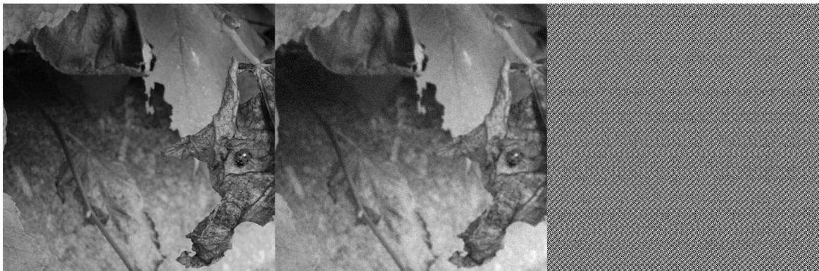
**Figura 6** Imagem original (à esq.), Imagem desfocada, B, usando PSF de dimensão [500x500], raio 2 e condições fronteira “periodic” (ao centro), Imagem recuperada (à dir.)
