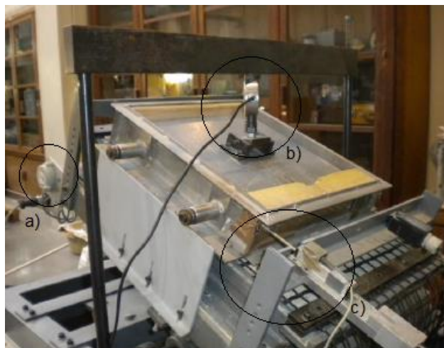
Figura 3.15 – Equipamento de ensaio de corte em plano inclinado: a) inclinômetro; b) célula de carga de compressão; c) transdutor de deslocamentos
