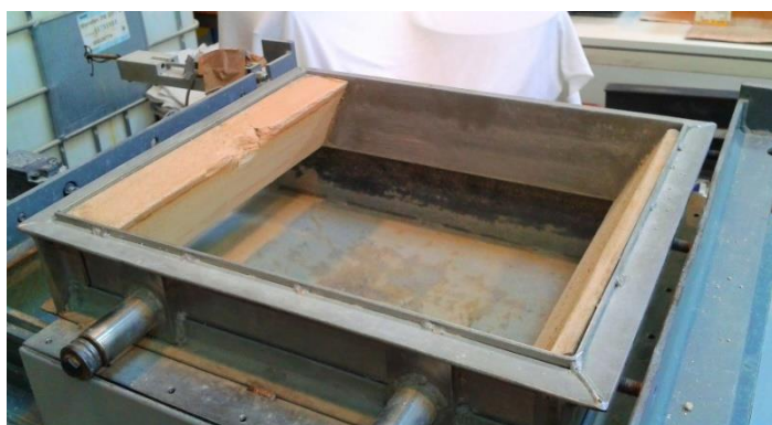
Figura 2.16 – Inclinação das paredes interiores da caixa de corte do equipamento de corte em plano inclinado do LGS da FEUP
