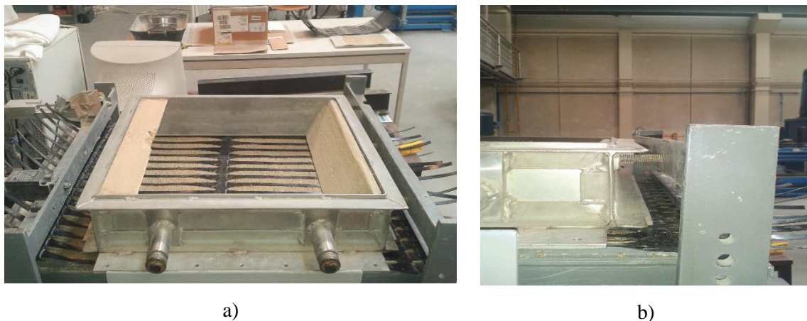
Figura 3.18 – Colocação da meia-caixa superior: a) sobre o geossintético e com folga de 0,5 mm; b) afastamento de 30 mm da extremidade a inclinar
