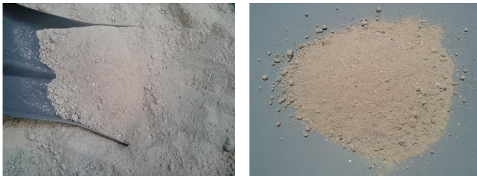
Figura 3.1 – Aspeto visual do solo residual de granito (SRG) no seu estado seco
