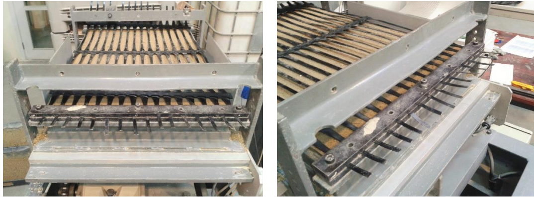
Figura 3.17 – Fixação do provete através de barras com sistema de aparafusamento
