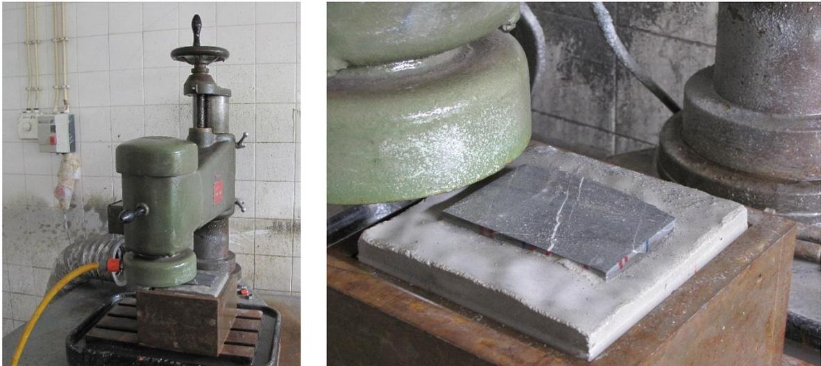
Fig. 39 – Preparação das superfícies serradas das diaclases com a mó
