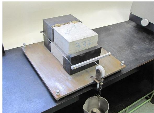
Fig. 31 – Aplicação da força horizontal no sistema do ensaio *pull* até ocorrer deslizamento
