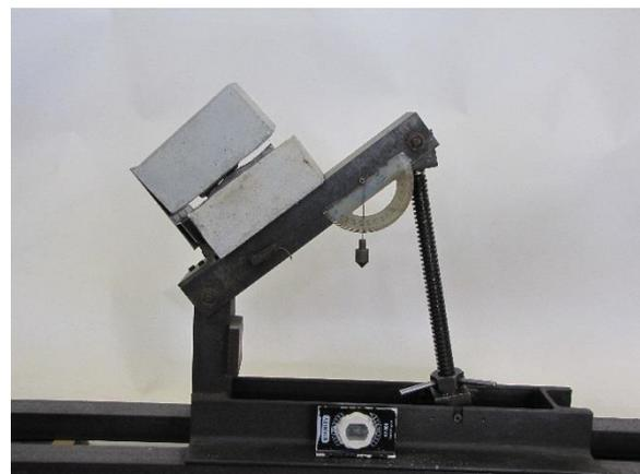
Fig. 35 – Inclinação progressiva da plataforma do ensaio até ocorrer deslizamento
