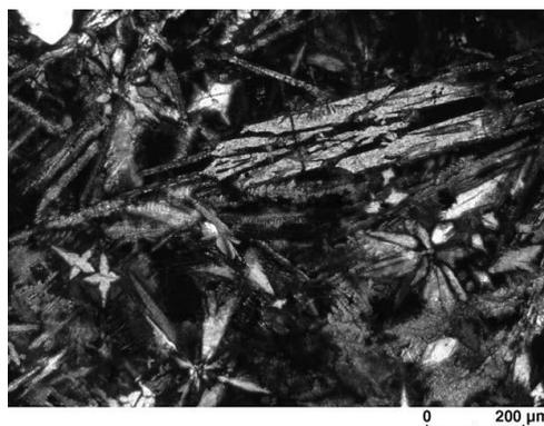
Figura 2.8 - Cristais de hedenbergite num agregado de CF, [50].
