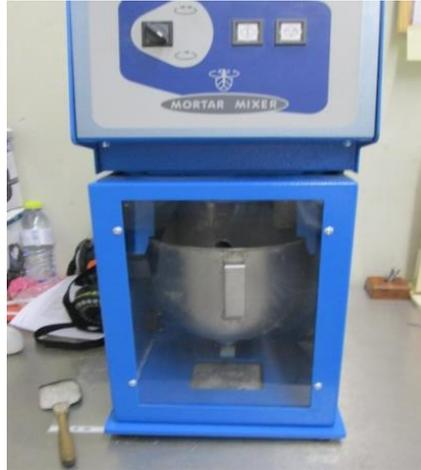
Figura 4.23 – Misturador mecânico usado do LMEC.
