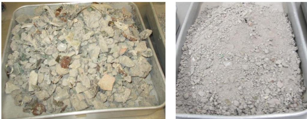
Figura 4.8 – Material rejeitado pela peneiração (esquerda) e material resultante da peneiração (direita).
