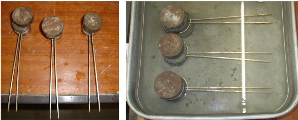
Figura 4.27 – Aparelhos de Le Chatelier com placas de ferro e embebidos em água.
