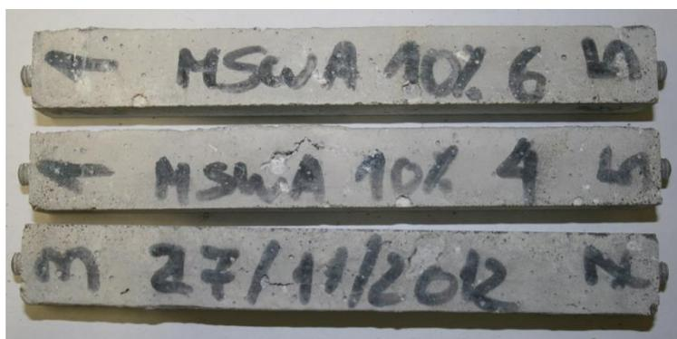
Figura 6.4 – Provetes com MSWA, com fissuras, bolhas e fragmentação.
