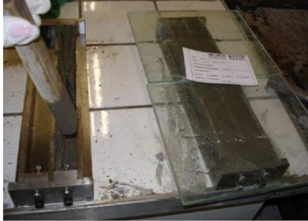
Figura 4.52 - Compactação da argamassa no molde do ensaio ASR.
