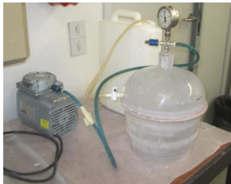
Figura 4.45 – Câmara de saturação.
