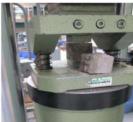
Figura 4.35 – Fim do ensaio à compressão.
