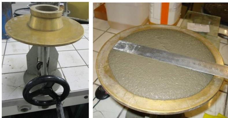
Figura 4.31 – Equipamento de medição da trabalhabilidade.
