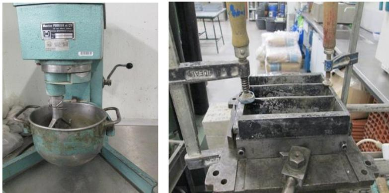
Figura 4.30 - Misturador mecânico e compactador mecânico (60 pancadas num minuto) do LEMC.
