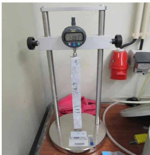
Figura 4.53 – Equipamento de medição da expansão ASR.
