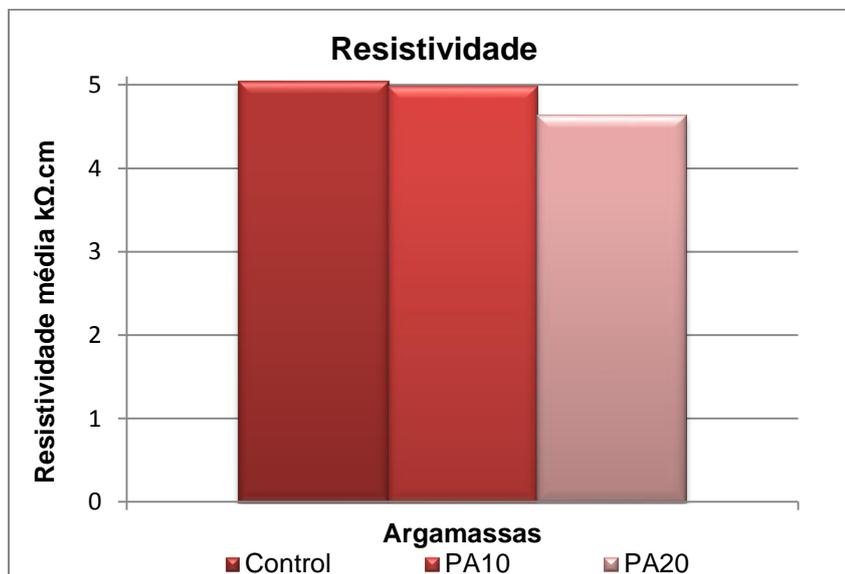
Figura 4.50 – Resistividade para argamassas.
