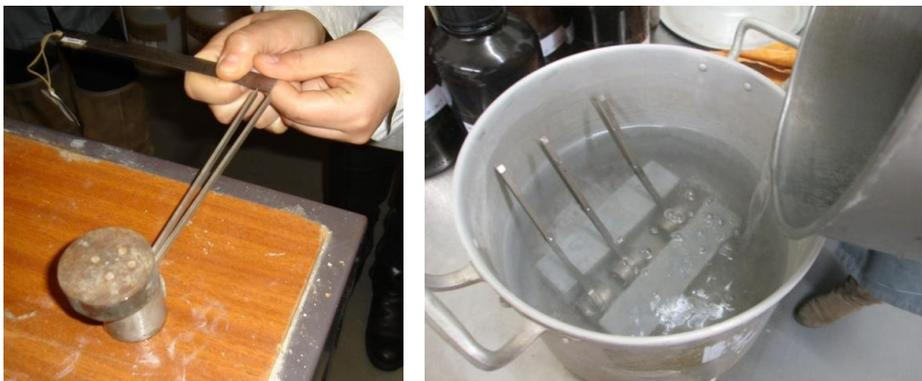
Figura 4.28 – Medição da distância entre as agulhas e fervura dos moldes.
