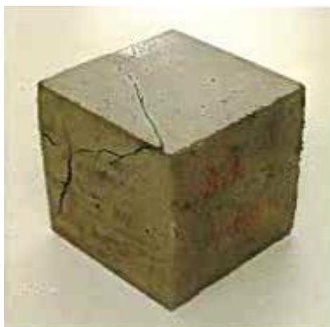
Figura 2.19 – Aspeto de um provete de betão de escórias da LIPOR [55].
