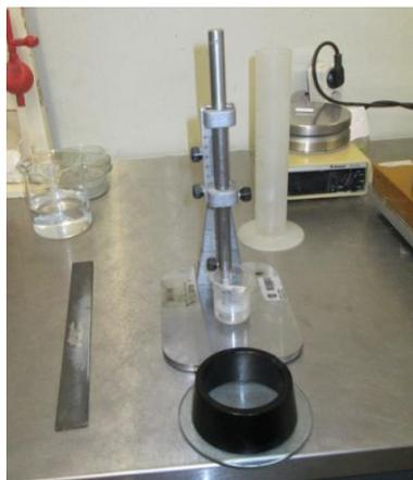
Figura 4.24 – Aparelho de Vicat, sonda e molde para determinação da consistência normal do LMEC.
