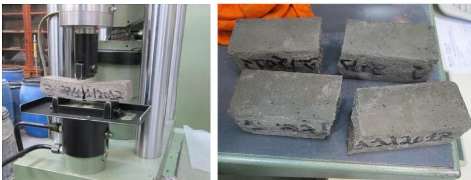
Figura 4.34 - Ensaio à flexão e meios prismas resultantes.
