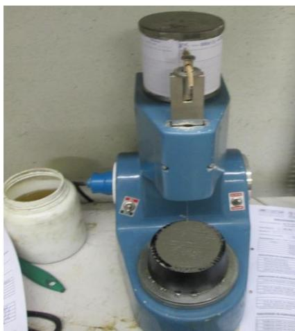
Figura 4.25 – Aparelho de Vicat mecânico.
