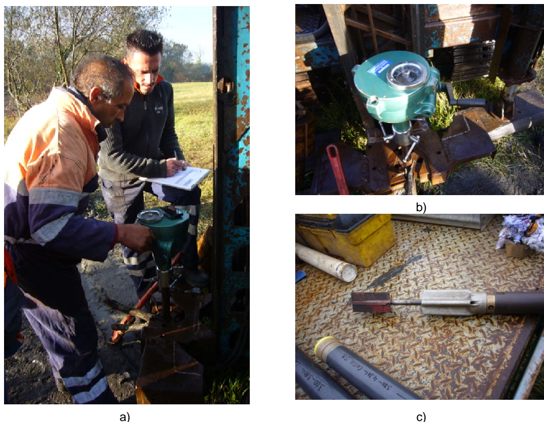
Figura 8.51 – Ensaio de corte rotativo in situ ( field vane test ): a) equipamento GEONOR H10 durante a realização do ensaio; b) unidade de medição do torque; c) molinete e invólucro protetor (fotografias da autora).
