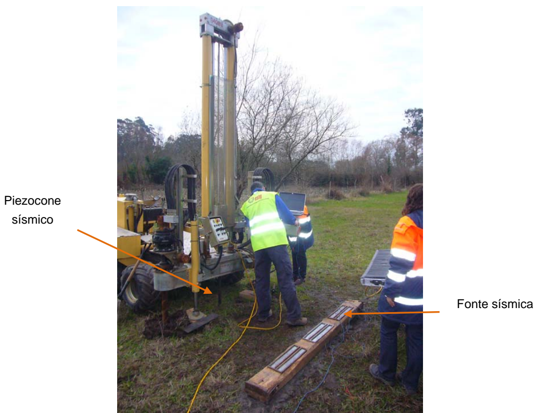
Figura 8.25 – Geração de ondas de sísmica de corte (fotografia da autora).
