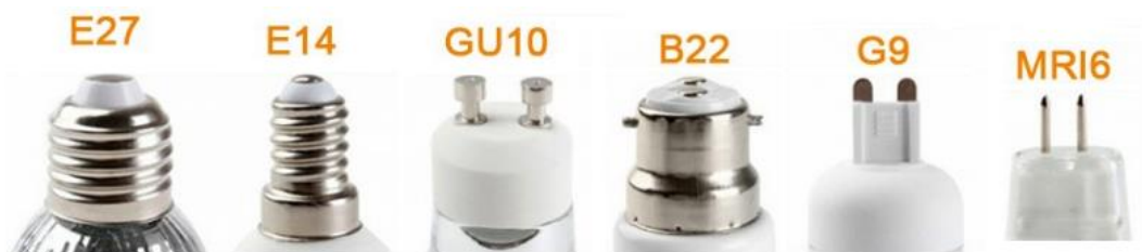
Figura 25: diferentes casquilhos utilizados na iluminação artificial [40]
