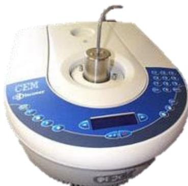
Figura 3.1 – Exemplo de micro-ondas utilizado na síntese assistida por micro-ondas.
