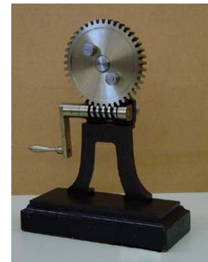
Figura 7 – Coleção Reuleaux da FEUP, Mecanismo de Sem -Fim/Roda-de-Coroa
