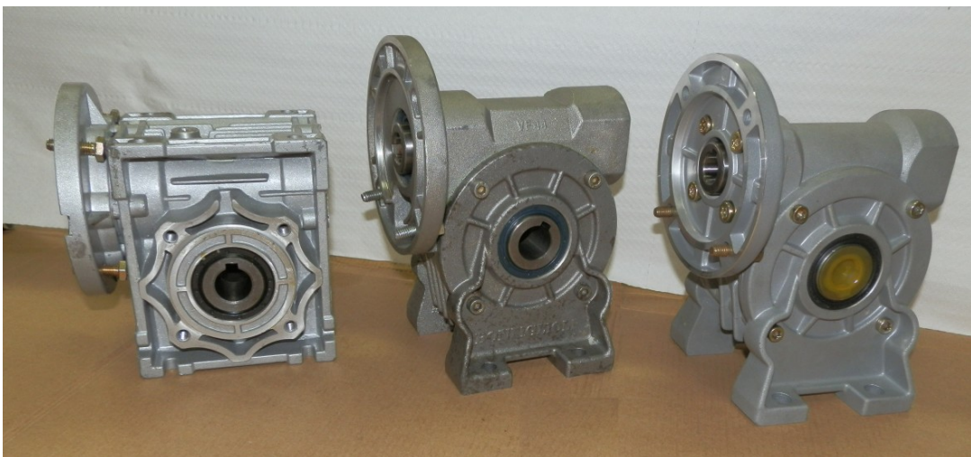
Figura 25 – Redutores em ensaio RMG040 :: VF 44 :: CH04
