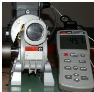
Figura 35- Localização da sonda termopar em cada redutor:
