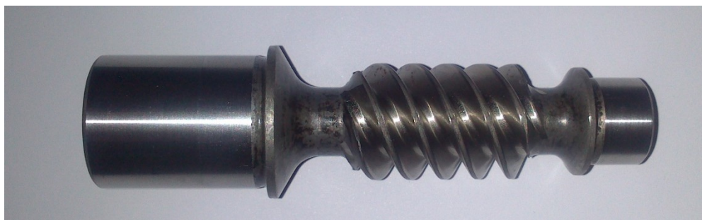
Figura 45 RMG 040-Pormenor do veio do sem-fim com helicoidal de 4 entradas
