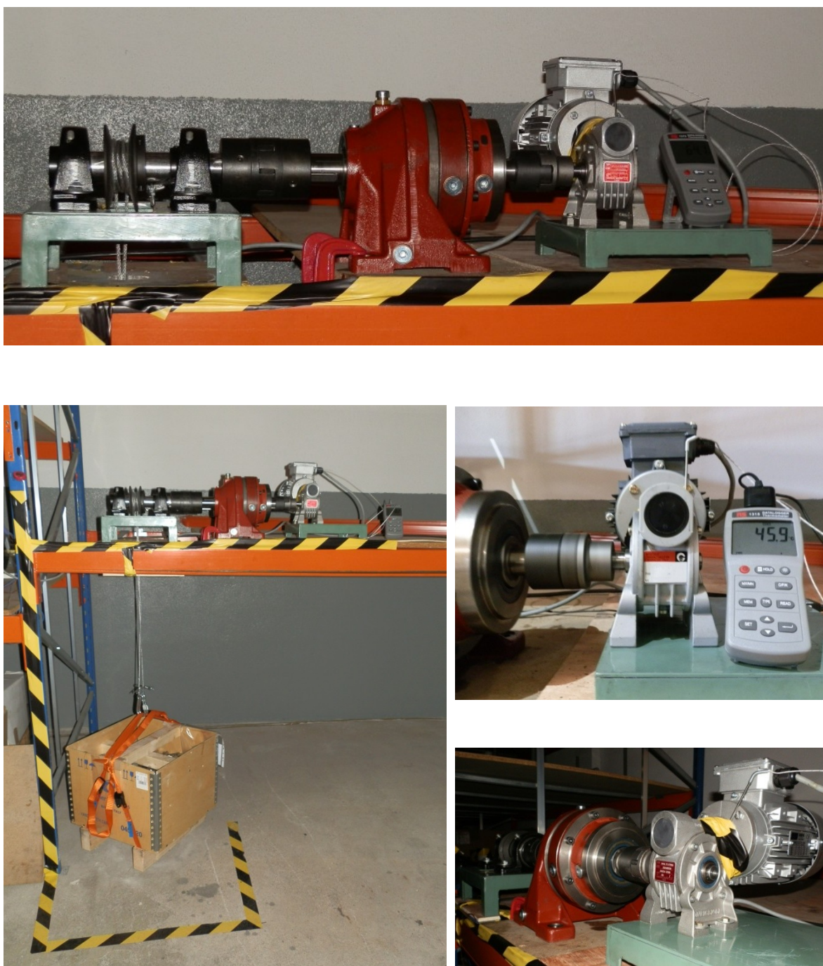
Figura 28 - Fotos várias do banco de ensaio utilizado no teste dos redutores
