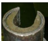
Figura 8- Parte do calço de posição que deve estar voltada para cima.
