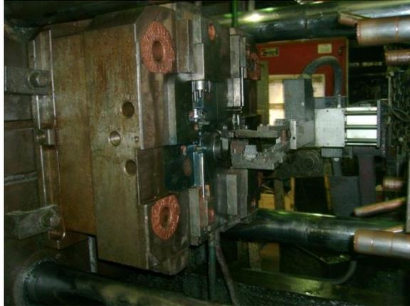
Fig. 28 – Extrator de peças afinado de acordo com a bolacha do molde móvel.
