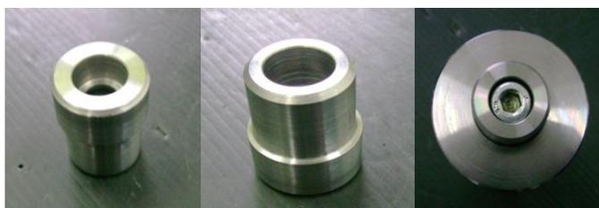
Fig. 35 – Pino de centragem com diâmetro de 25mm (à esquerda) e 22mm (ao centro) e simulação do encaixe do pino no molde (à direita).
