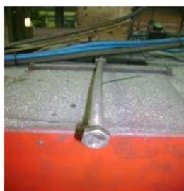
Figura 2- Fuso que permite deslocar o suporte da cabeça de lubrificação.
