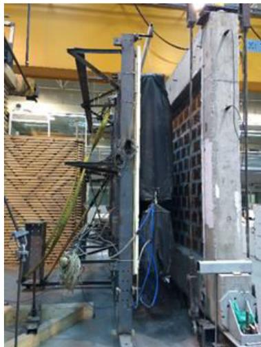
Figura 4.1. Aspeto geral da estrutura metálica construída no Laboratório LESE para realização de ensaios para fora-do-plano de paredes de enchimento.
