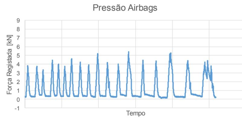
Figura B. 3. INF 05: Representação gráfica da pressão do sistema de airbags ao longo do ensaio.
