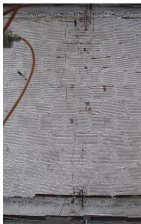
Figura 6.15. Ilustração da fissura vertical observada no painel INF 04.
