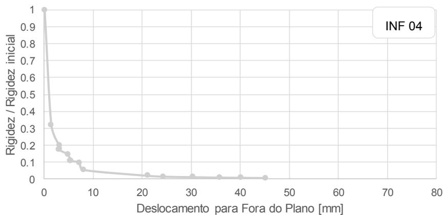
Figura 4.21. Resultados experimentais da parede INF 04: Rigidez Secante ao longo do ensaio.
