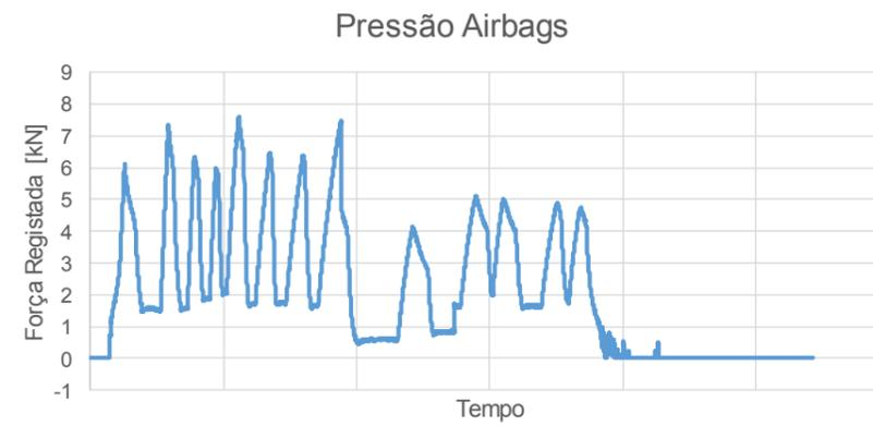
Figura A. 6. INF 04: Representação gráfica da pressão do sistema de airbags ao longo do ensaio.
