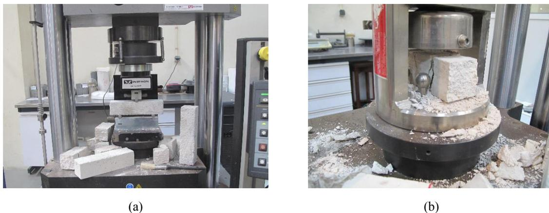
Figura 3.9. Registo fotográfico relativo aos ensaios realizados sobre os provetes de argamassa (a) provete submetido ao ensaio à flexão (b) provete submetido ao ensaio de compressão.
