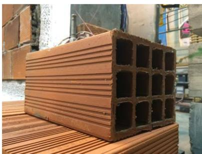
Figura 3.2. Tijolo cerâmico de dimensões  $0,30 \times 0,20 \times 0,15 \text{ m}$  da *PRECERAM*.
