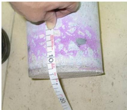
Figura 7: Medição da profundidade de carbonatação
