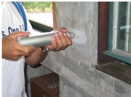
Figura 6: Determinação da classe do betão com recurso ao esclerómetro
