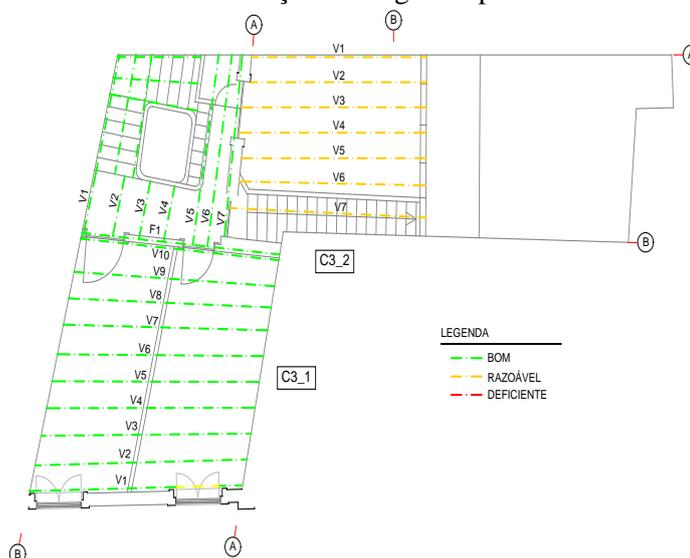
Figura 24: Classificação do estado de conservação das vigas no piso 3
