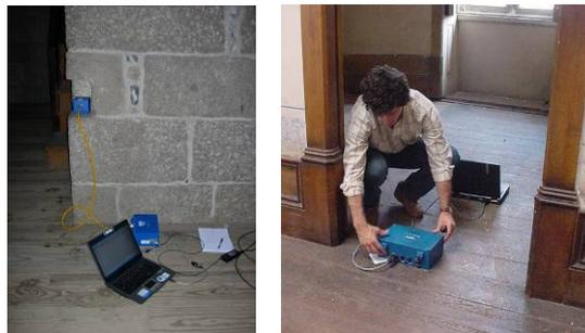
Figura 5: Ensaios de identificação dinâmica
