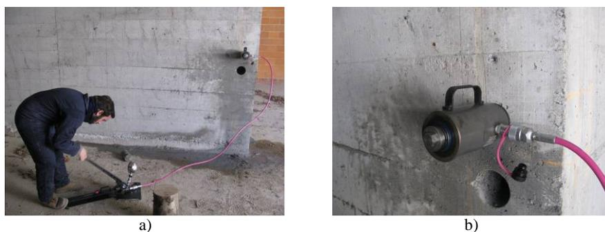
Figura 11: a) Medição *in situ* da resistência ao arranque b) pormenor da fotografia anterior
