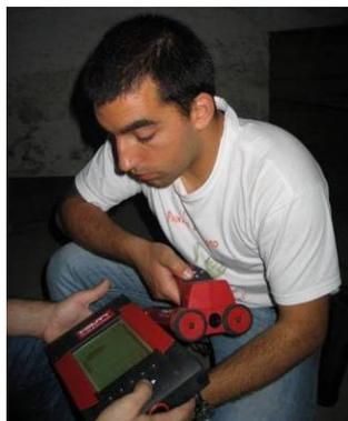
Figura 8: Identificação de armaduras em lajes com recurso ao pacómetro
