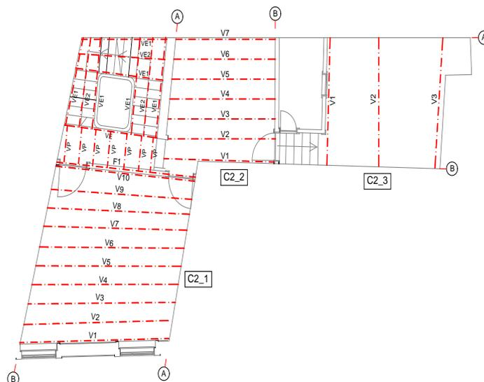
Figura 20: Identificação estrutural dos compartimentos do piso 2
