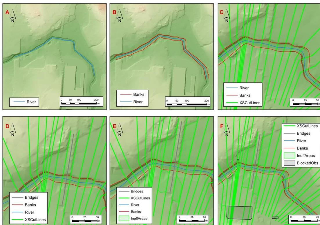
Figura 21 - Variáveis que compõe o modelo hidráulico.
