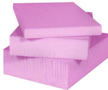
Fig. 5.16 - Poliestireno extrudido de alta densidade [17]
