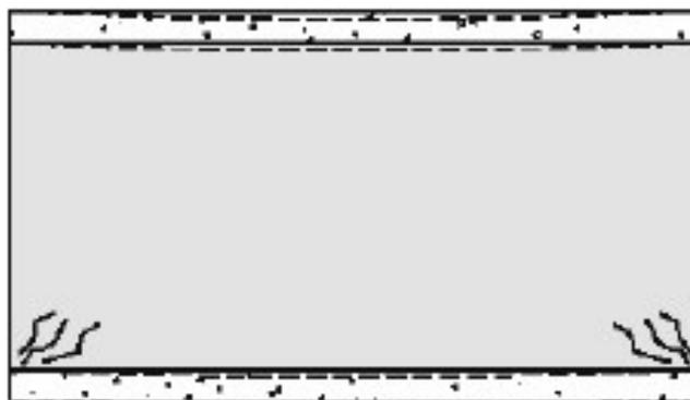
Fig. 2.9 - Paredes de alvenaria sem aberturas de portas ou janelas - laje inferior e superior com deformações aproximadamente iguais [9]
