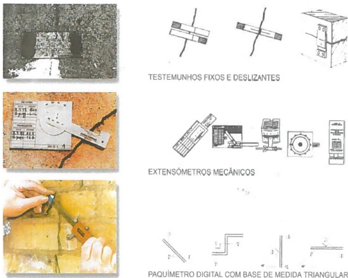
Fig. 5.21 - Exemplos de equipamentos e procedimentos para acompanhamento da evolução das fissuras em paredes [7]
