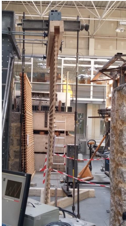
Fig.6.21 – Vista transversal da deformação da parede – PTS – CC
