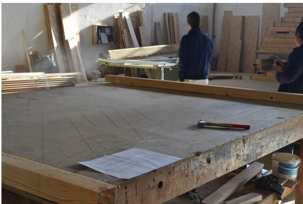
Fig.5.8 – Colocação dos frechais na mesa de construção
