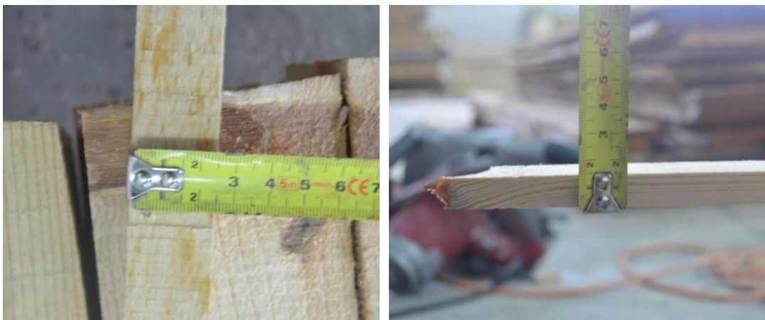
Fig.5.6 – Ripas (largura e espessura)
