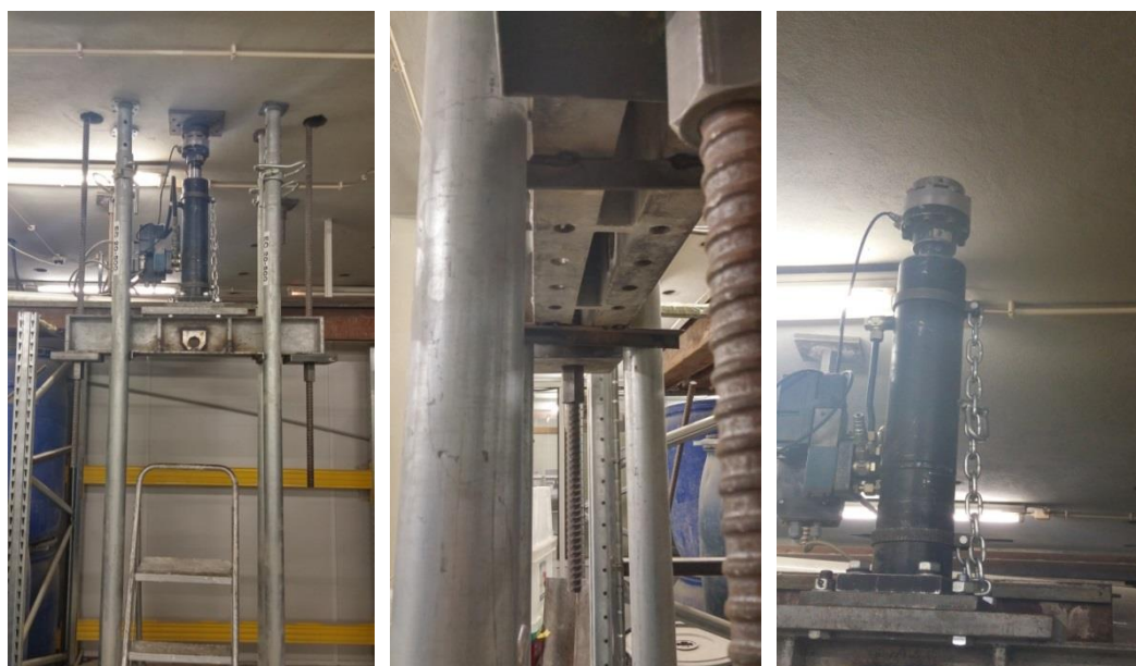
Fig.5.27 – a) guias; b) perfis; c) macaco e célula de carga (no topo do macaco)
