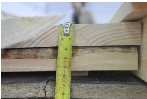
Fig.5.12 – Espessura das tábuas de madeira (tábua vertical e diagonal)
