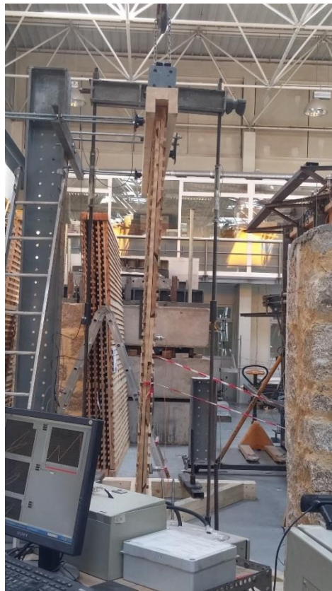
Fig.6.39 – Vista transversal da deformação da parede – PTD – CC
