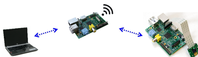
Figura 4.7: Comunicação através de um Access Point
