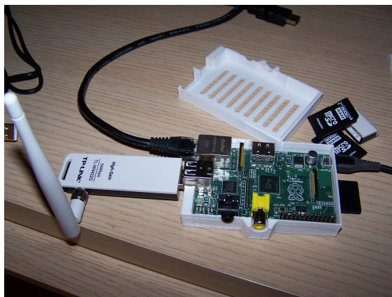
Figura 4.6: Nó de rede - Raspberry Pi contendo o sistema operativo OpenWrt
