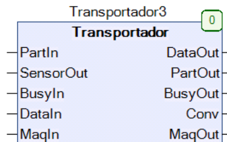
Figura 4.42 - POU do equipamento de transporte
