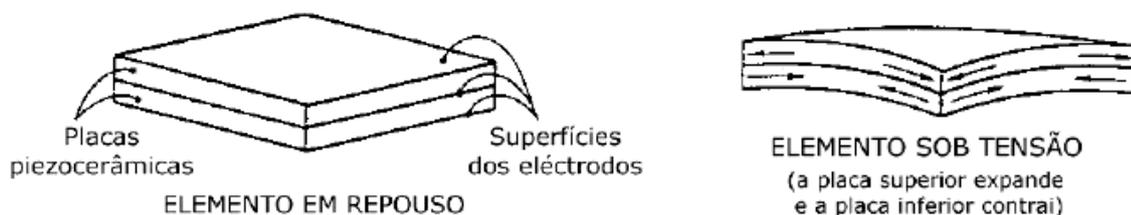
Figura 3.28 – Esquema de um elemento piezocerâmico duplo em repouso e sob tensão (adaptado de Dyvik e Madshus, 1985)
