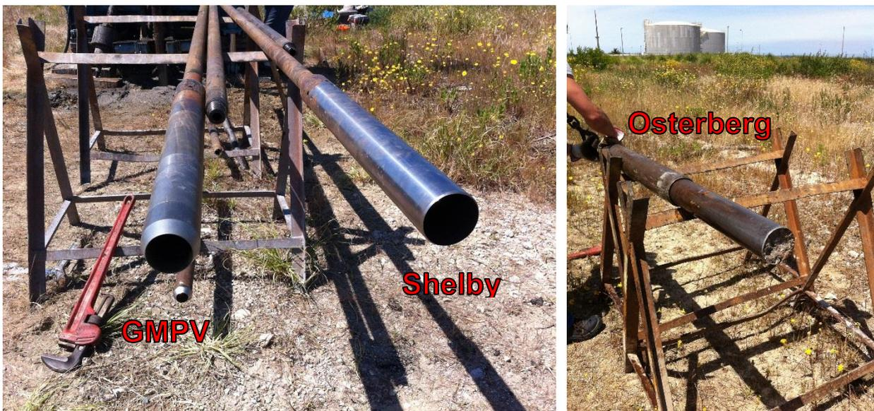
Figura 3.6 – Fotografia dos amostradores utilizados para recolha de amostras no campo experimental
