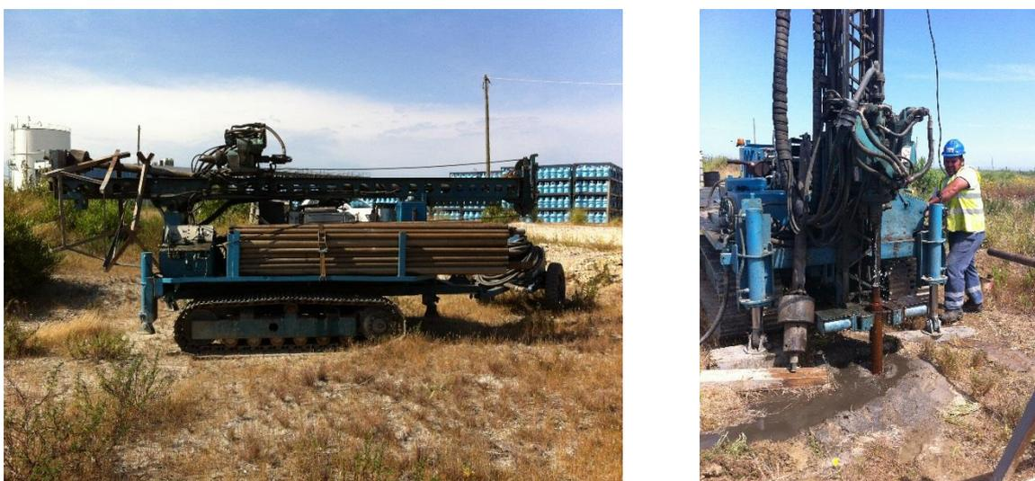
Figura 3.7 – Equipamento utilizado na realização de sondagens à rotação
