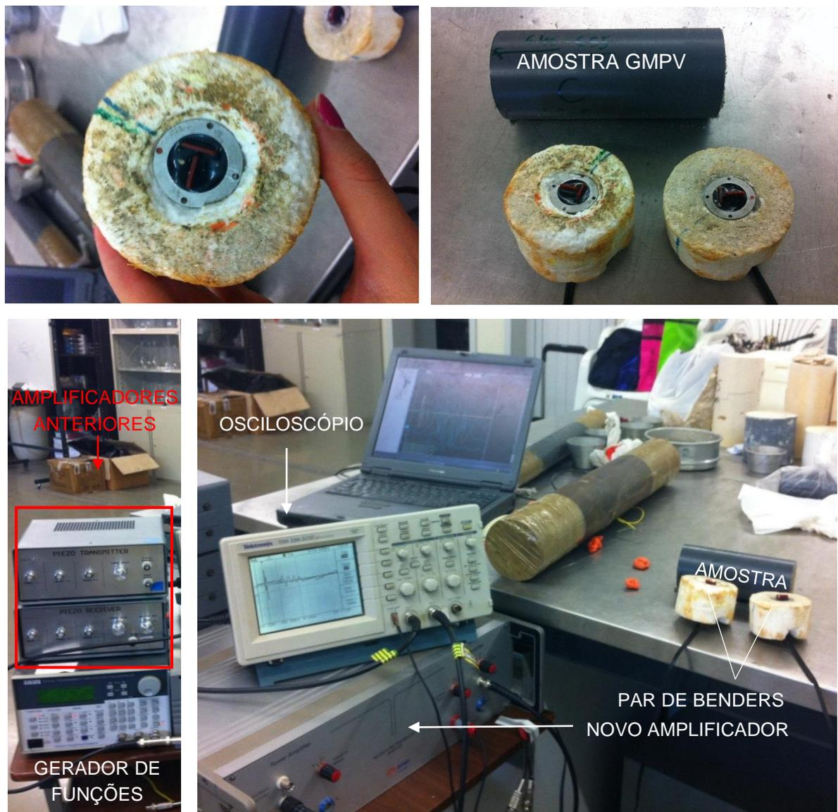
Figura 4.6 – Equipamento necessário à leitura das ondas de corte diretamente nos tubos amostradores
