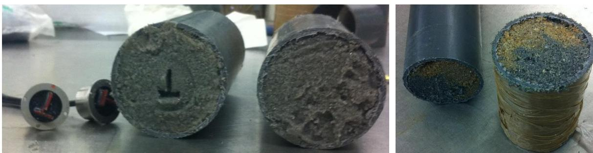
Figura 4.7 – Amostras de solo arenoso colhidas com o tubo amostrador GMPV submetidas ao ensaio sísmico
