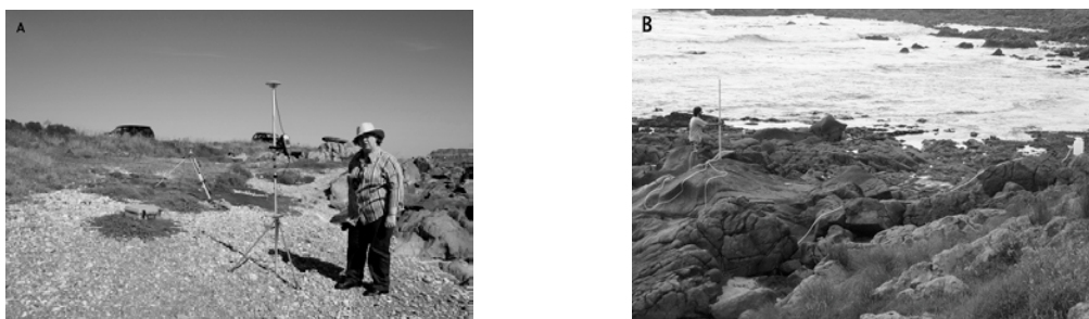
Figura 1. Dispositivos usados na medição das superfícies costeiras: (A) GPS Leica/SR20 e (B) dispositivo de vasos comunicantes.
