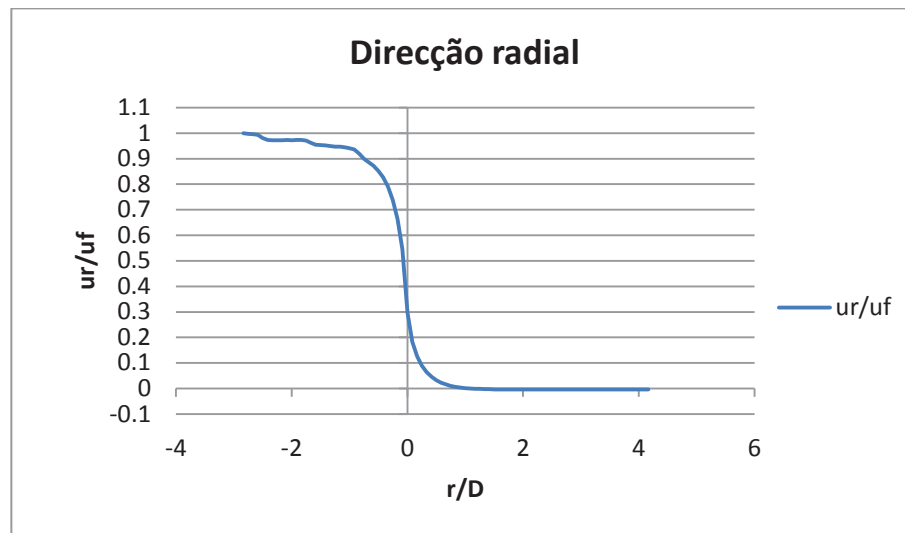
Fig. 5.66 - Deslocamentos radiais normalizados em função da relação da distância à frente e do diâmetro, para o modelo axissimétrico elástico
