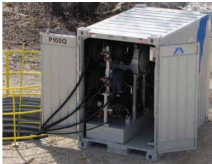
Fig. 3.45 – Unidade primária de alimentação hidráulica, Power Pack A100Q (Akkerman 2011)
