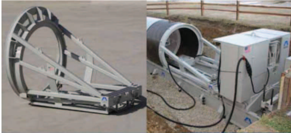
Fig. 3.29 – Equipamento de empurre com estrutura móvel sobre estrutura fixa (Akkerman 2011)
