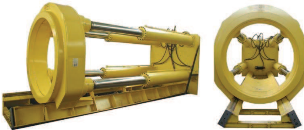
Fig. 3.28 – Equipamento de empurre com cilindros telescópicos hidráulicos, SEGOQUI HT-2000 (TalleresSegovia 2009)
