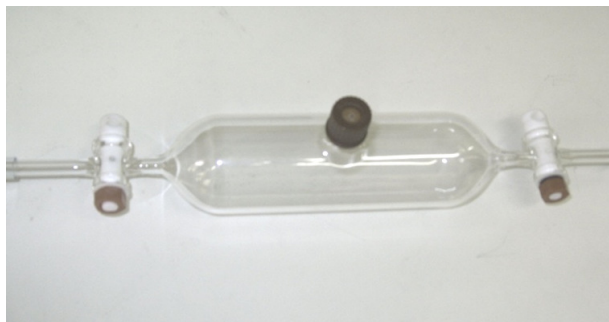
Figura 2.11-Ampola de vidro utilizada para a preparação dos padrões.
