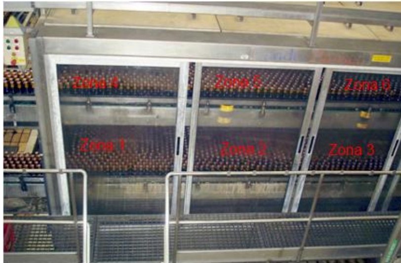
Figura 29: Zonas do Pasteurizador definidas no método de validação
