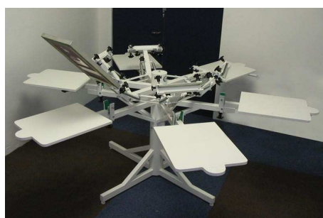
Figura 7. Representação da estampagem ao quadro plano descontínuo [31]
