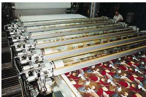
Figura 8. Representação da estampagem ao quadro rotativo [32]
