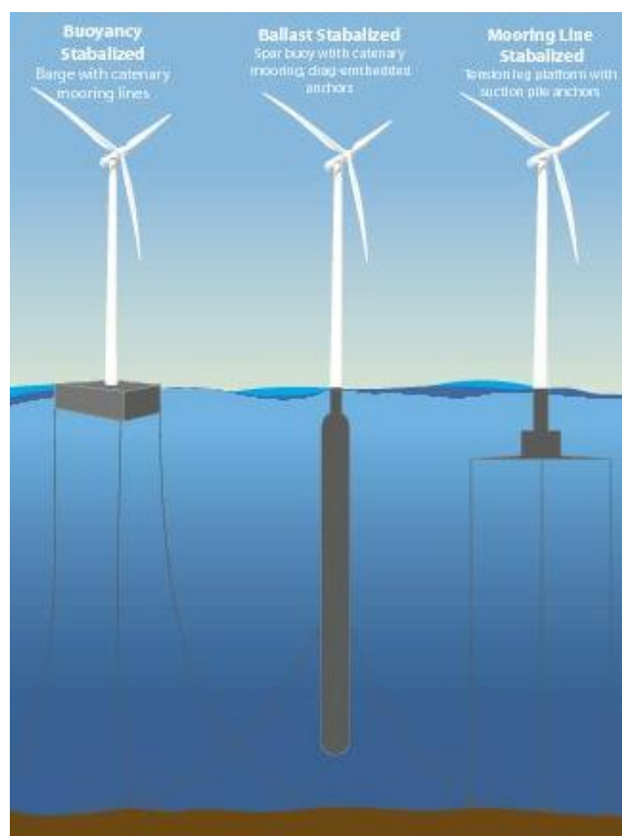
Fig.2.15 – Plataformas flutuantes para torres eólicas offshore, respetivamente o Modelo de Boia Ancorada, Spar Buoy, e Tension Leg Platform [14]
