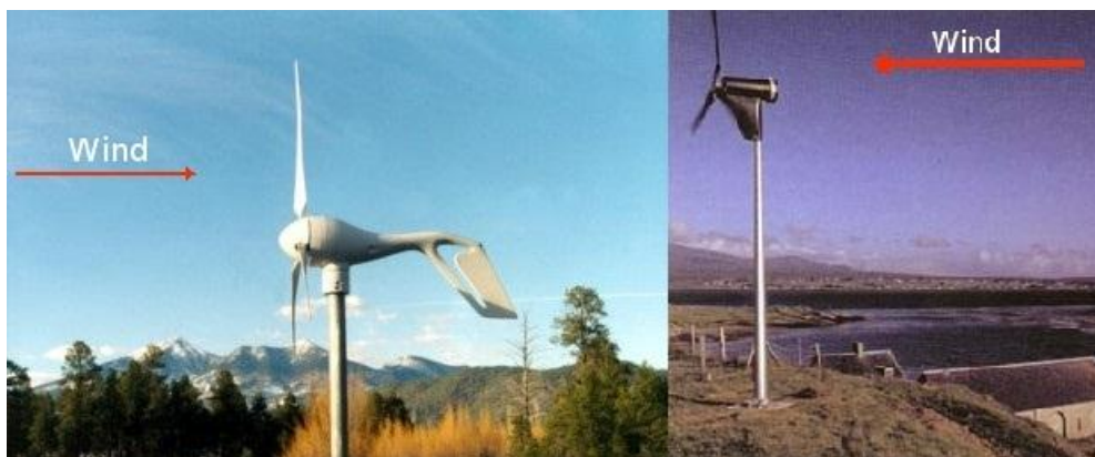
Fig.2.7 – Comparação entre turbinas com rotor a contravento e a favor do vento [10]
