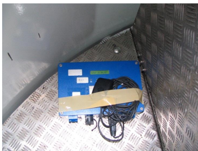
Fig.5.6 – Um dos sismógrafos instalados na torre
