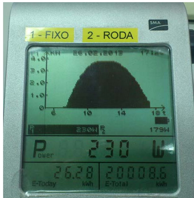
Figura 5.21: Gráfico da potência ao longo do dia 26 da instalação fixa
