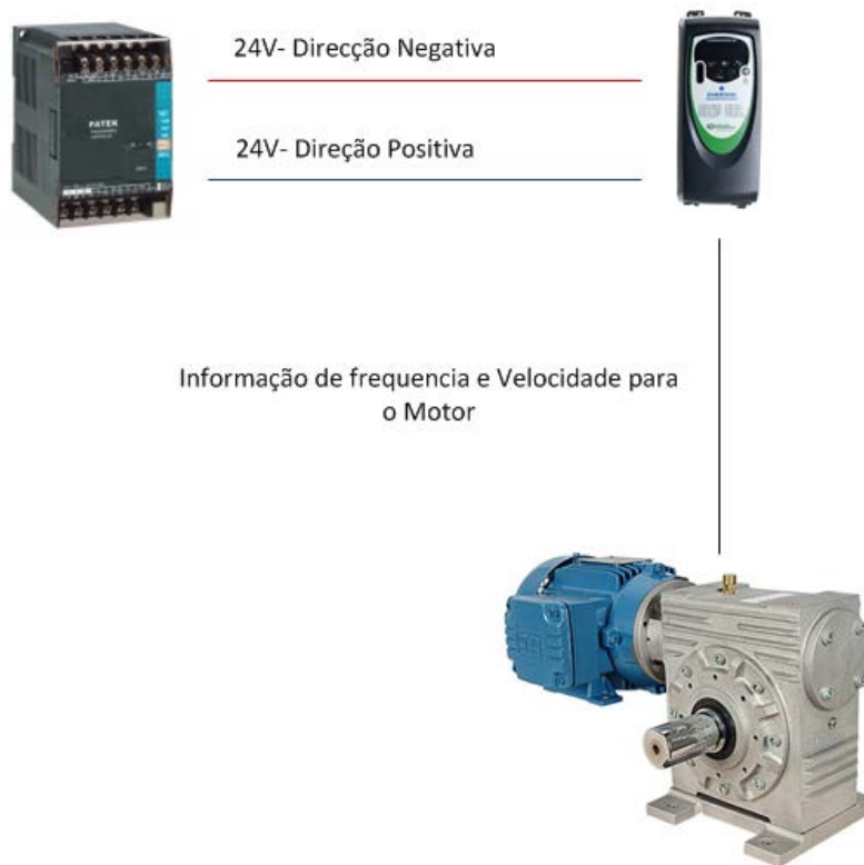
Figura 3.6: Sistema de controlo da Roda simplificado
