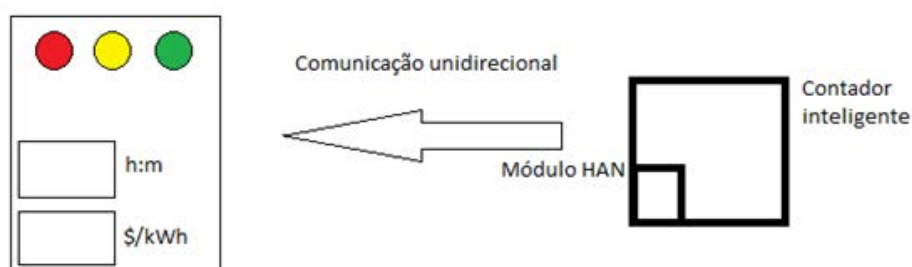
Figura 4–4 - Caracterização do sentido e da forma de comunicação feito entre o contador inteligente e o dispositivo SmarTraffic.
