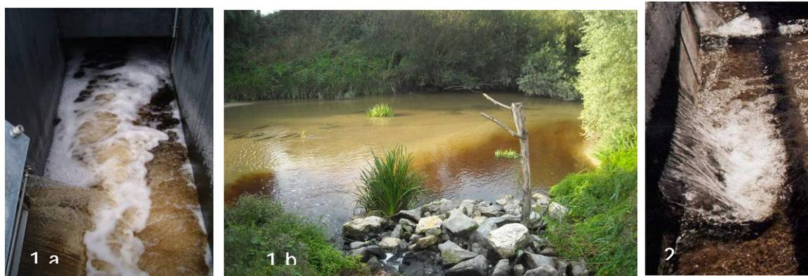
Figura 2.1.1- Aspecto do efluente tratado em ETAR urbana: Caso 1- ETAR a receber 1% de lixiviado de um aterro 1. a - saída da ETAR 1. b - impacto no meio receptor. Caso 2 - ETAR que não recebe lixiviado.
