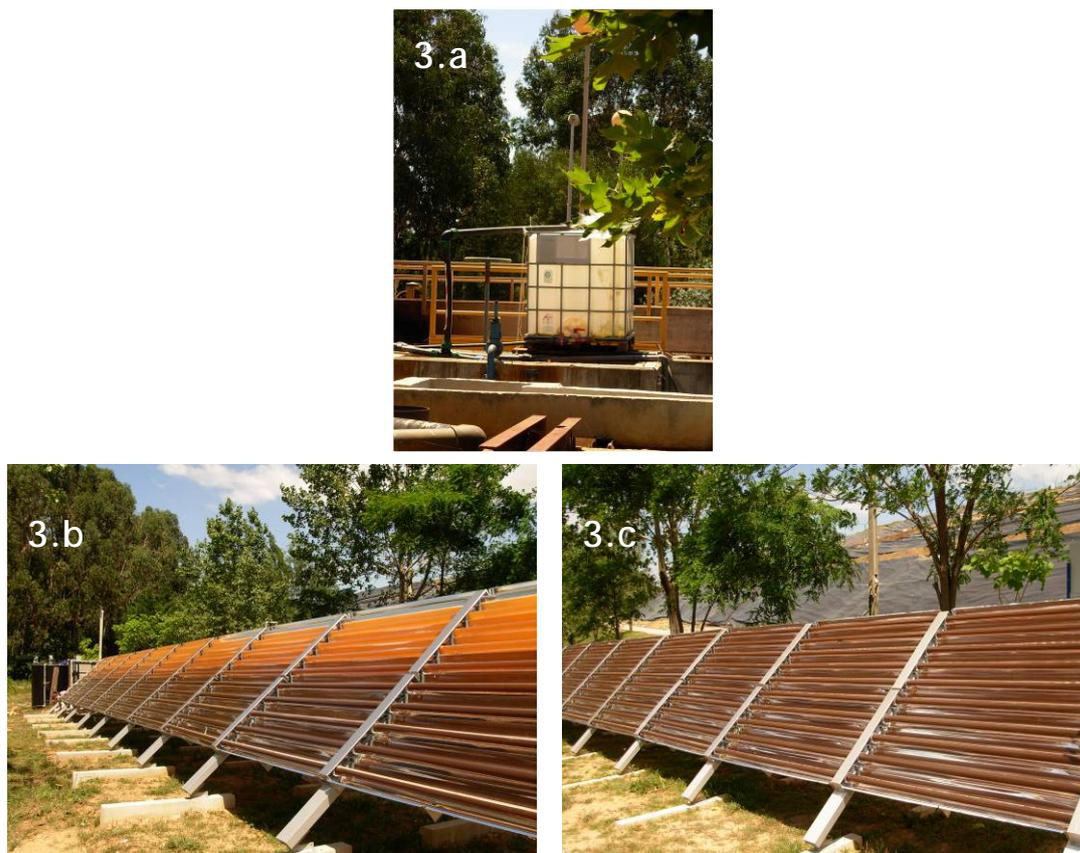
Figura 3.5.1 - Ensaio de Fototratamento: 3.a - Contentor com funções de decantador; 3.b - Antes da colocação do contentor; 3.c - Após colocação do contentor
