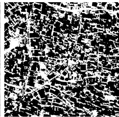
Fig. 74 - Amostra L convertida em imagem binária usada p/ análise de índices de Densidade e Lacunaridade.
