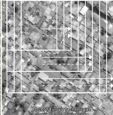
Fig. 45 Amostra D convertida em imagem de 8 bits 356x356 pixels e explicação do processo de contagem do algoritmo sliding box .
