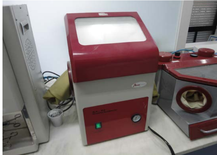
Figura 35 – Máquina odontológica AX – P3 Powerful Sandblaster utilizada para alisar as peças através de abrasão por areia de 250 microns. Este processo foi feito de leve para não danificar dimensionalmente as peças.
