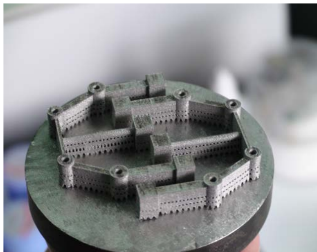
Figura 31 – Peças para estudo dimensional em cromo-cobalto produzidas pela Realizer SLM 50. Pela foto consegue-se evidenciar os suportes que prendem as peças à base. Há que reparar na grossura dos suportes. Ao retirar as peças da base, foi necessário exercer muita força.
