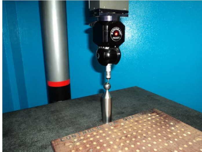
Figura 39 – Calibração da ponta de prova na esfera retificada, fixa na mesa da CMM.
