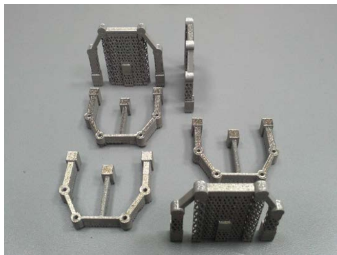
Figura 29 – Peças padrão em titânio, produzidas pela SLM 100 com suportes grossos.
