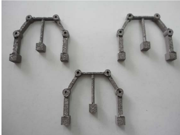
Figura 32 – Peças produzidas pela SLM 100 em titânio com os suportes removidos. Nota-se ainda restos de suportes.
