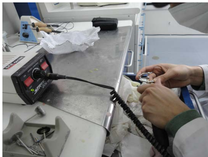
Figura 34 -- Remoção dos restos de suportes com uma broca dentária Saeshin Strong 204 .
