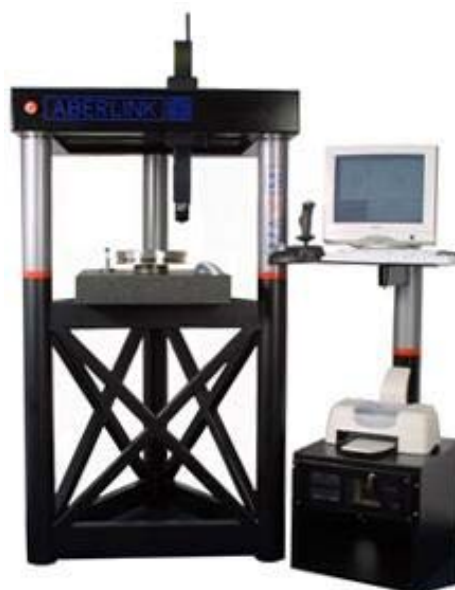
Figura 11 – Máquina CMM Aberlink Maxim , utilizada para medir as peças produzidas. [24]
