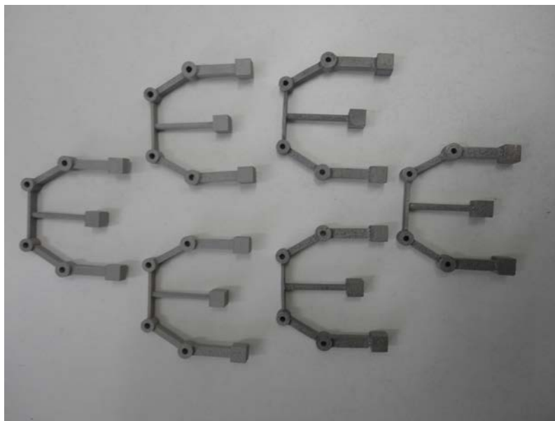
Figura 36 – Peças padrão depois de terem sido acabadas. À esquerda, as três peças em cromo cobalto produzidas pela SLM 50. À direita, as três peças em titânio produzidas pela SLM 100.
