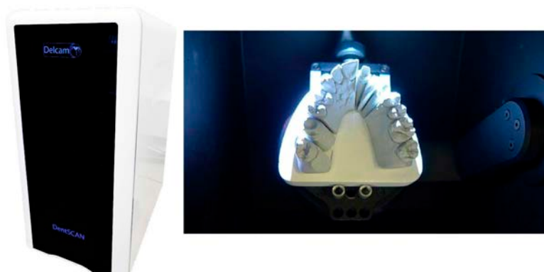
Figura 1 – Exemplo de um scanner extraoral – Dentscan, da marca Delcam. À direita podemos ver um modelo em gesso a ser digitalizado dentro do scanner.
