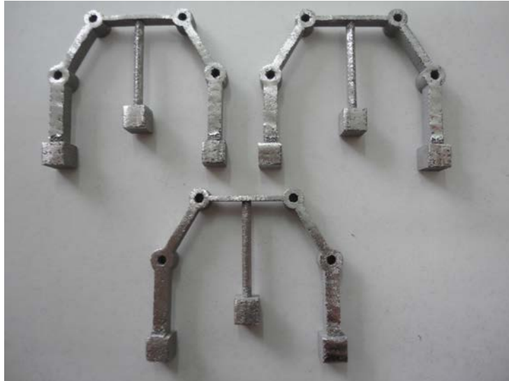
Figura 33 – Peças produzidas pela SLM 50 em cromo-cobalto com os suportes removidos, com menos restos de suportes que as produzidas pela SLM 100. A remoção dos suportes com alicate nas peças em cromo-cobalto foi bem mais fácil, devido ao facto de os seus suportes serem menos resistentes do que os suportes das peças em titânio.
