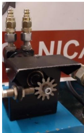
Figura 2.7 - Motor hidráulico instalado na banca.
