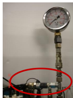
Figura B 7 - Implementação de derivação para servir transdutor de pressão.
