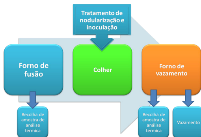
Fig. 22 – Esquema do processo de controlo de produção em forno de vazamento automático [28]
