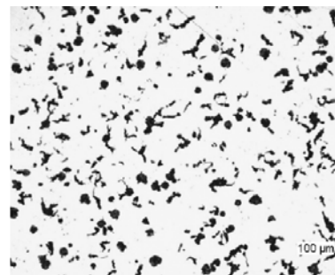
Fig. 14 - Microestrutura de um ferro compacto apresentando 20% de nodularidade
