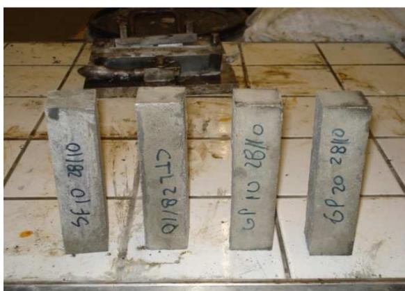
Figura 3.20 – Provetes prismáticos (40x40x160mm).
