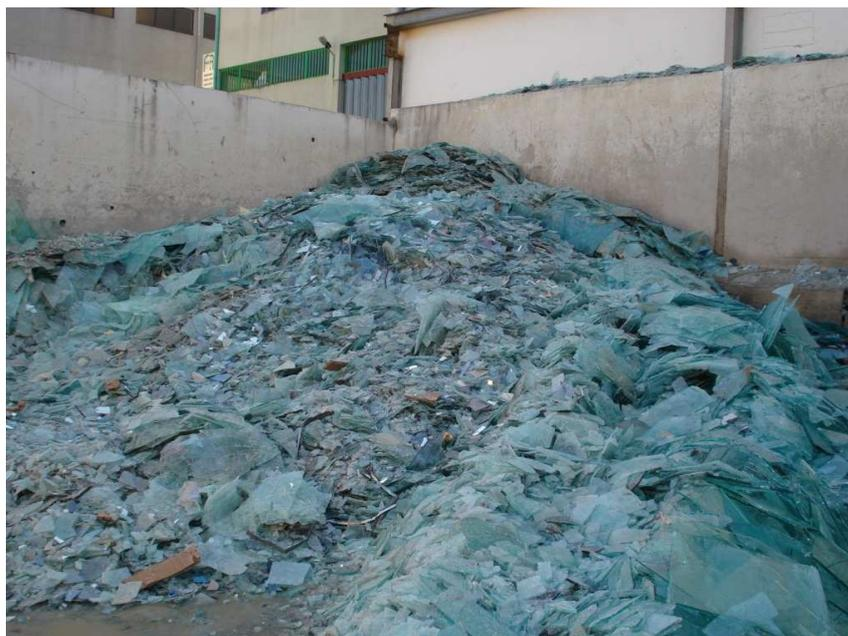
Figura 3.3 - Restos de vidros de indústrias vidreiras que chegam à fábrica de reciclagem.
