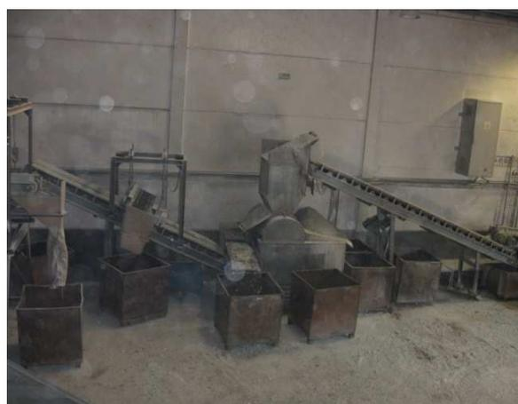
Figura 3.4 - Vista do sistema automático de britagem e moagem.
