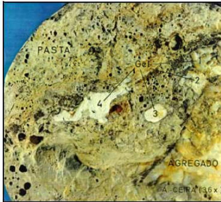
Figura 2.8 - Reacção álcali-silica reactiva. Estados de alteração (1 a 4) de quartzo-filoneano em gel (Silva, 1992).
