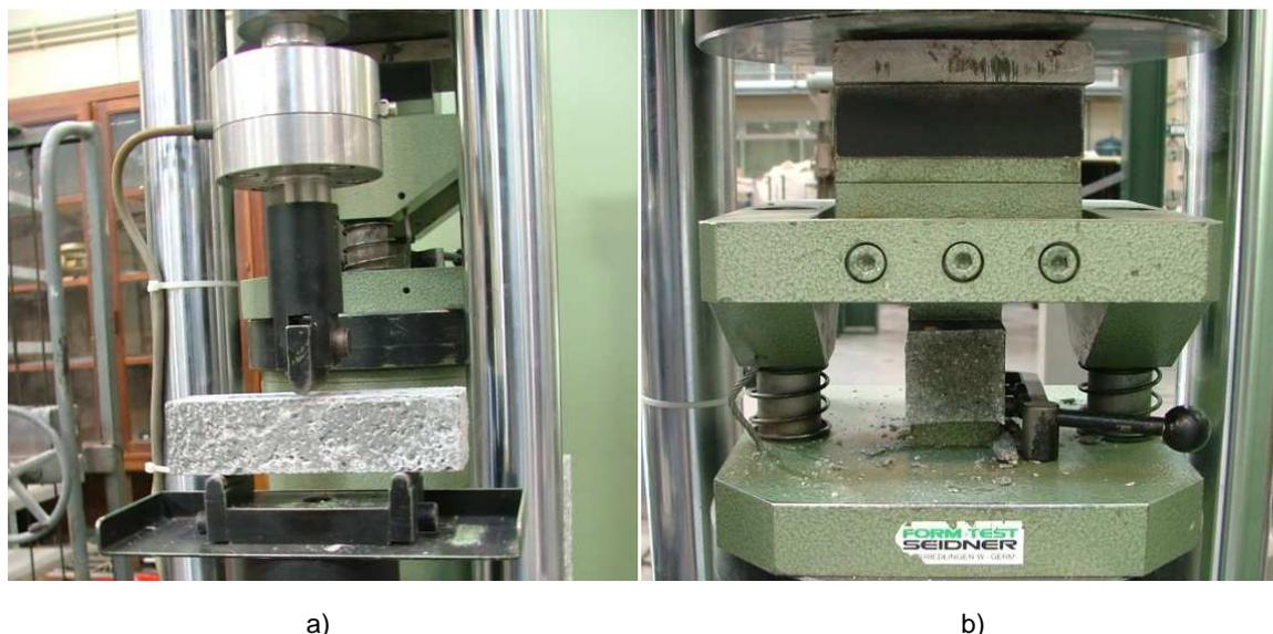
Figura 3.21 - Ensaio de resistência, flexão (a) e compressão (b).
