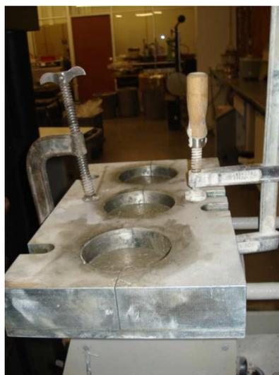
Figura 3.32 - Compactação dos moldes para o ensaio de penetração de cloretos.
