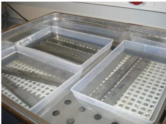
Figura 3.35 - Provetes em banho-maria e submersos em NaOH nos recipientes.
