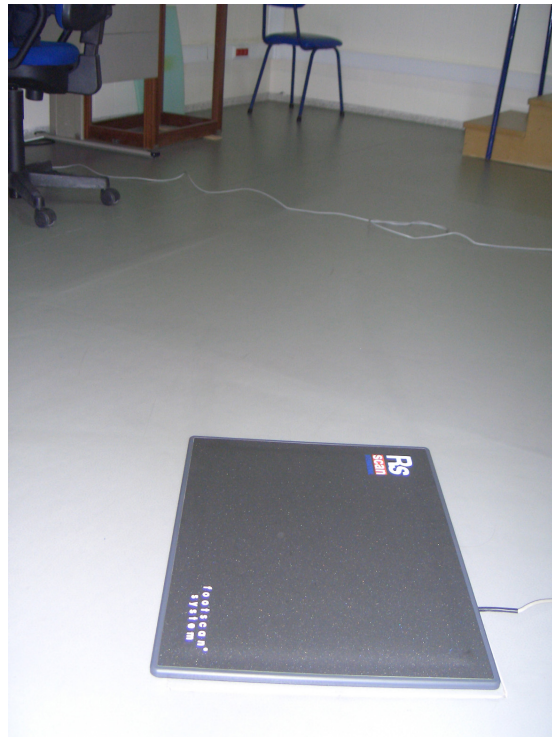
Figura 3.9. Plataforma de pressões da RSscan modelo Footscan 3D existente no laboratório do CRPG.
