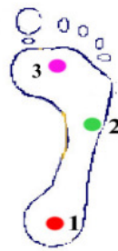
Figura 20- Localização dos termopares para medição da temperatura durante os dois regimes de velocidade [27]
